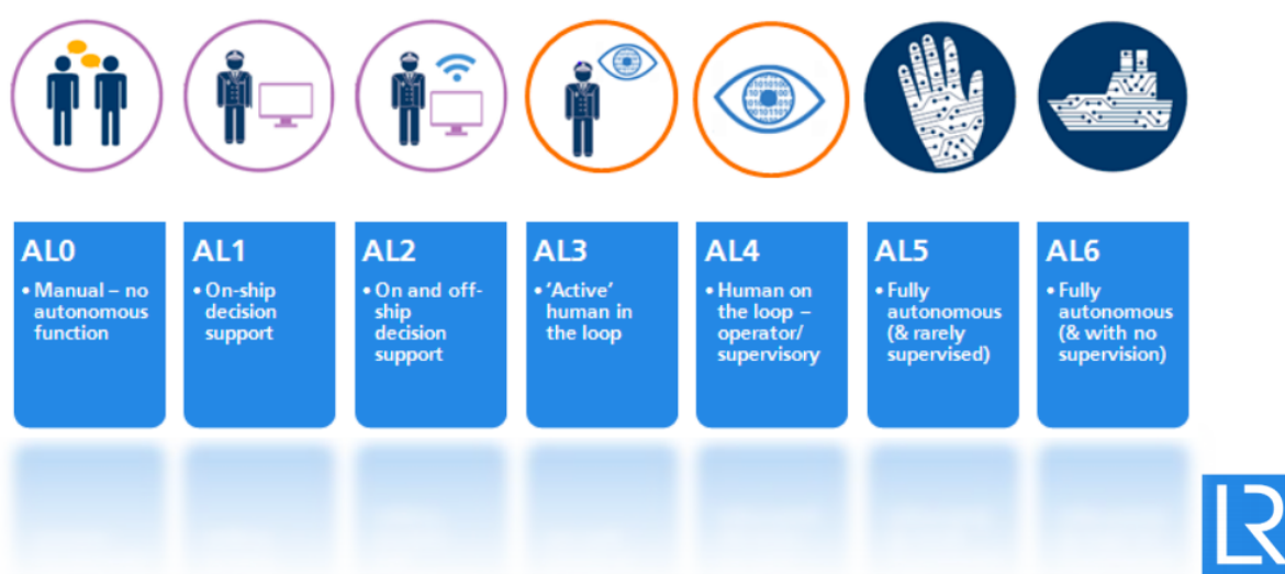
Figur 2: Lloyd's Registers beskrivelse for grader av autonomi.
