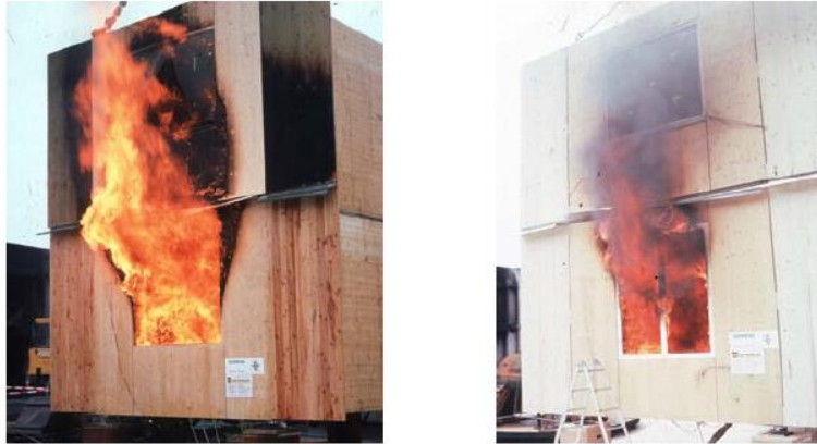
Figur 16. Bildet ble tatt etter 7 min. Rom med brennbare overflater til venstre, ubrennbare til høyre
