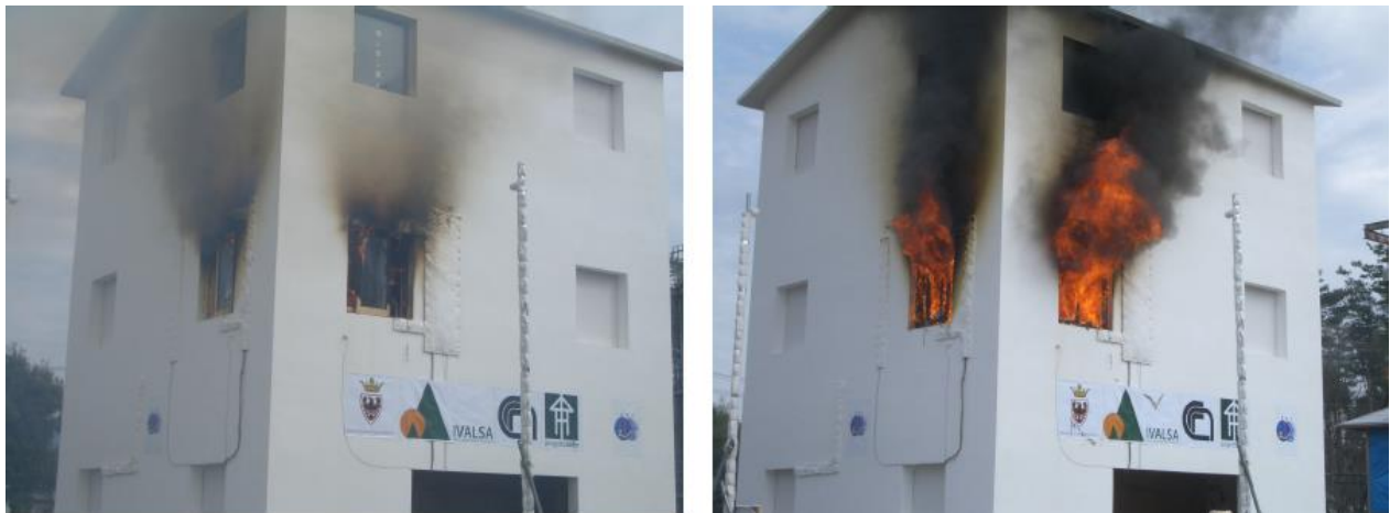
Figur 21: Brannutvikling 32 minutter (venstre) og 40 minutter (høyre) etter brannstart [43]
