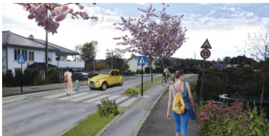
Figur 83: Med skille mellom gange og sykkel, grønn midtrabatt og overgangsfelt, vil Hjortevegen bli bedre for folk i området. (Illustrasjon: Olafia Zoega Hentet fra: Nilsen, 2017).
