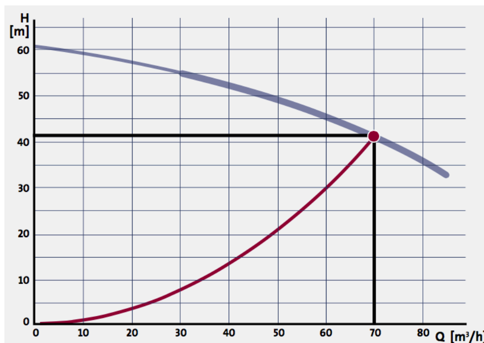
Figur 19 Illustrasjon av en pumpekurve som viser driftspunktet i sammenheng av løftehøyde og kapasitet
