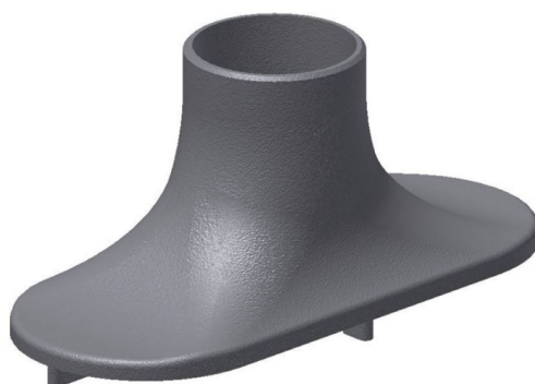
Figur 40 Bellmouth, som benyttes for å opprettholde sugetrykket når vannivået i ballastvanntankene synker
