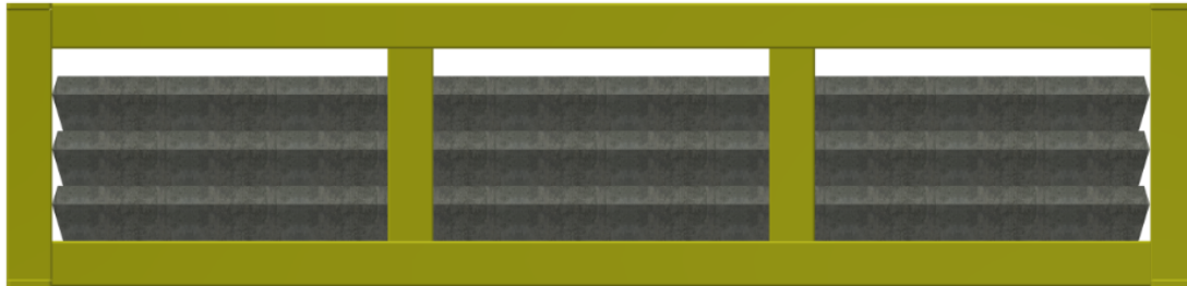
Figur 120 Konteiner med tre betongmadrasser sett fra siden
