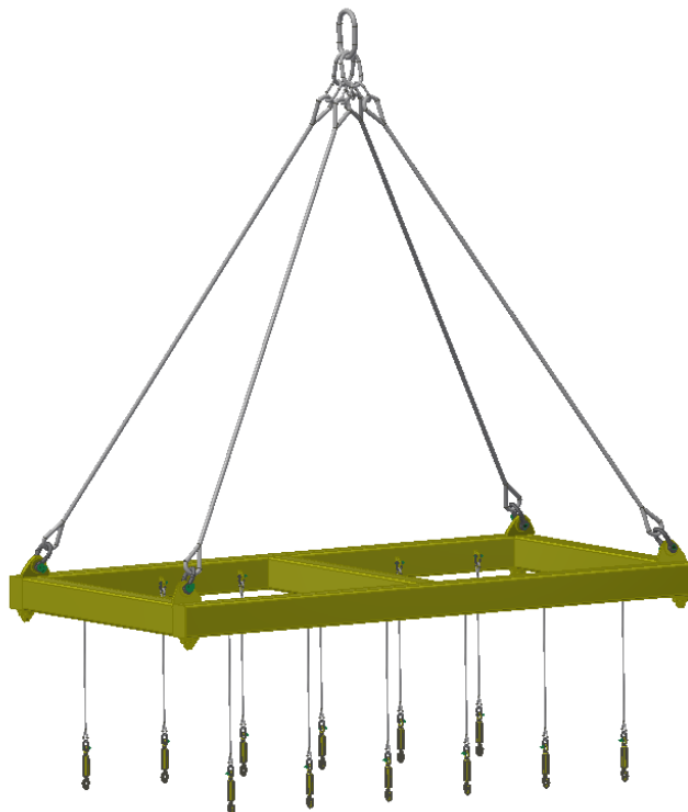
Figur 147 Rigging og stropper med ROV-krok
