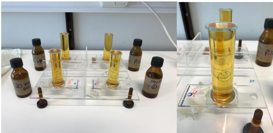
Figur 30: Sedimentering prosessen som ble brukt i forbindelse med algetellingen.
