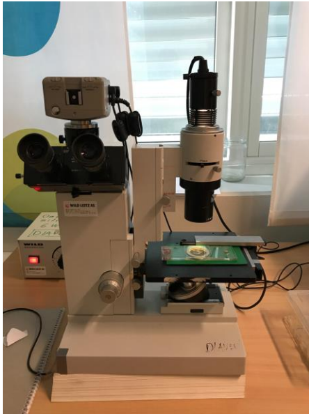
Figur 31: Omvendt mikroskop av typen Leitz Diavert, samt kamera koblet opp ved kikkehullene.
