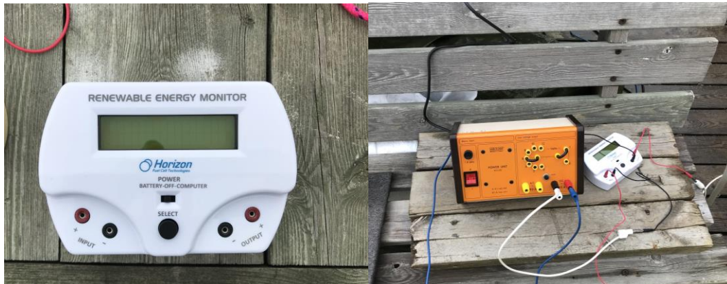
Figur 25: Måleren vi koblet inn i kretsen for å kunne måle den faktiske effekten, Volten og Amperen i elektroforesekaret.
