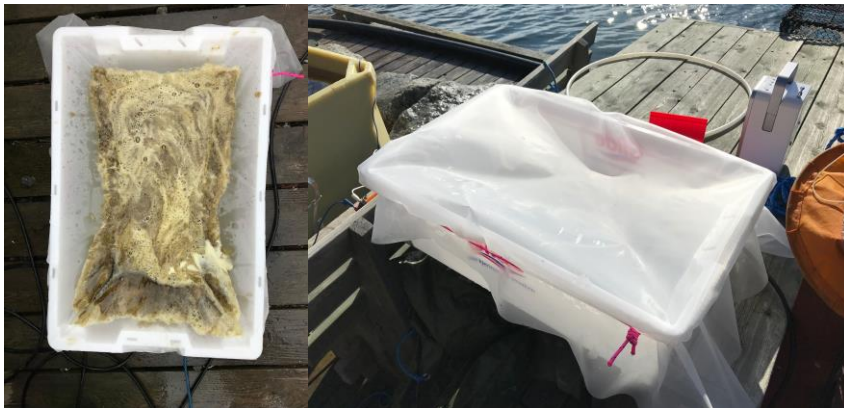
Figur 22: Mikroalge biomassen filtreres Figur 23. Filterduk i spenn over en Gildekasse.
