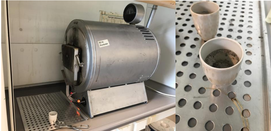
Figur 29: Ovnene som ble brukt til forbrenning, samt en digel med aske.
