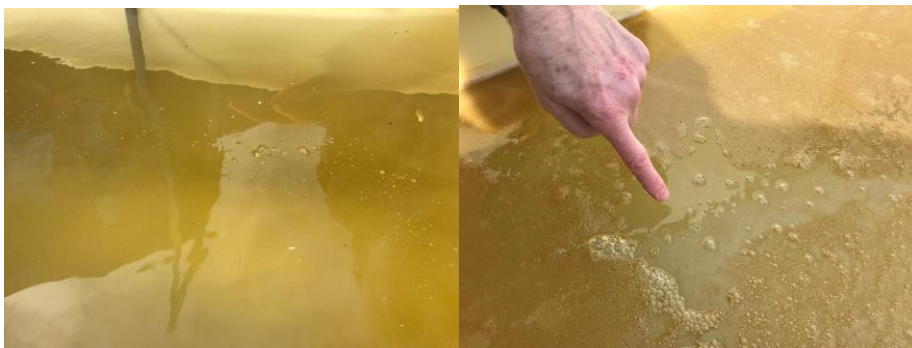
Figur 21: Hydrogen- og oksygenbobler fra elektroforese, samt belegg med mikroalger flokkulert ved vannoverflaten.
