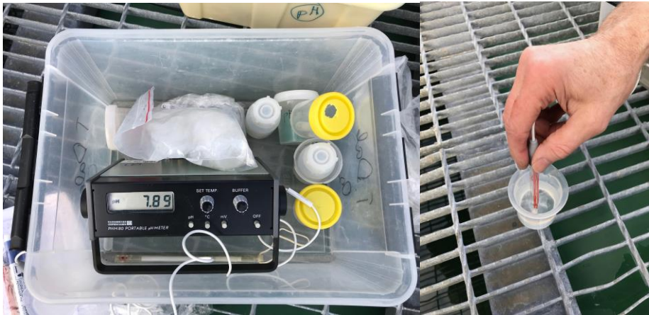
Figur 9: pH-måleren og prøveglass som de manuelle målingene ble gjort med.
