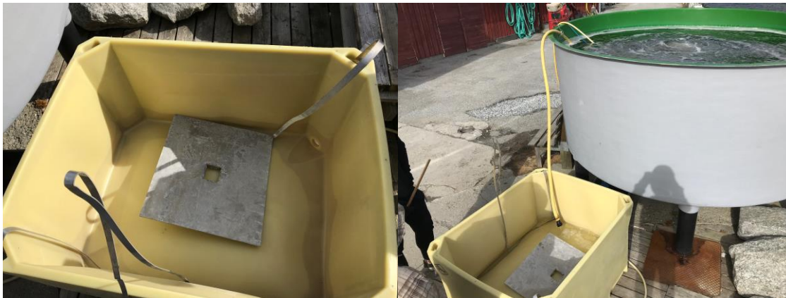
Figur 19: Elektroforesekaret med anode og katode på plass. Figur 20: Fylling av elektroforese-karet.
