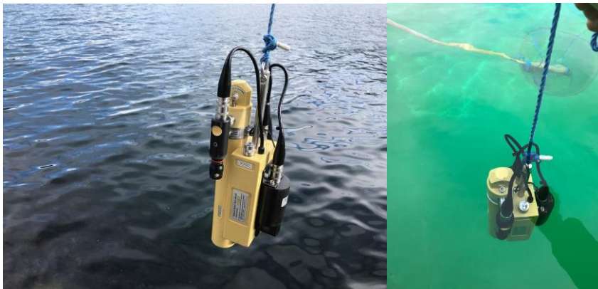
Figur 8: CTD-apparatet før og under en av målingene.
