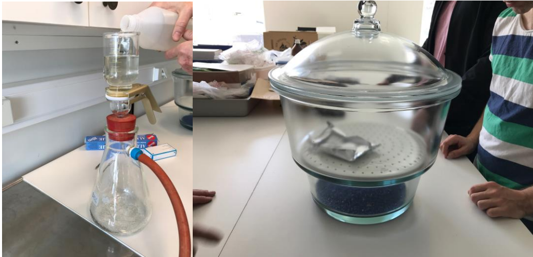
Figur 26: Vakuumpumpe til filterprøvene. Figur 27: Eksikator (avfuktighetskammer).
