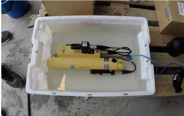
Figur 18: Metoden som ble brukt ved utvanning av vannet i karet, i en Gildekasse
