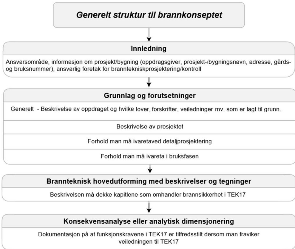
Figur 4. Strukturen til brannkonsept.
