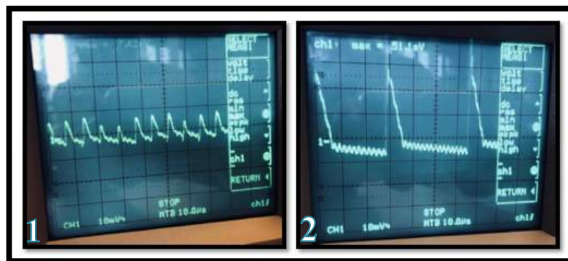
Figur 14: Målinger fra oscilloskopet, bilde 1 viser en original adapter med en jevn spenning og bilde 2 viser en uoriginal adapter med en ujevn spenning.
