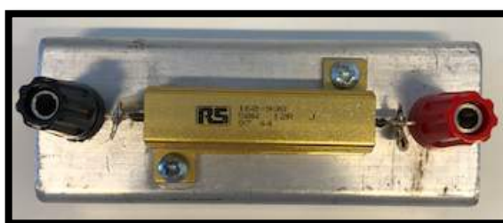
Figur 11: En motstand som ble tatt i bruk under forsøket.
