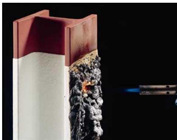
Figur 21: Viser en brannmalt søyle som utsettes for varmepåkjønning 39
