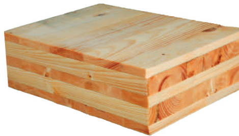
Figur 1: Eksempel på massivtre (5)
