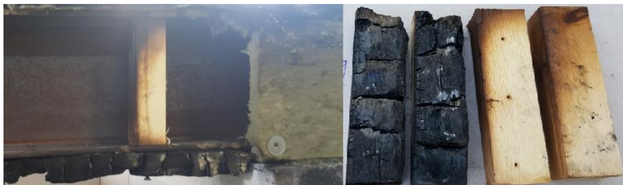
Figur 52 Prøvestykkets innfesting etter gjennomføring av 60 minutters forsøk
