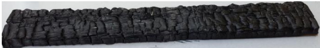
Figur 44 Prøvestykkets underside etter gjennomføring av 30 minutters forsøk
