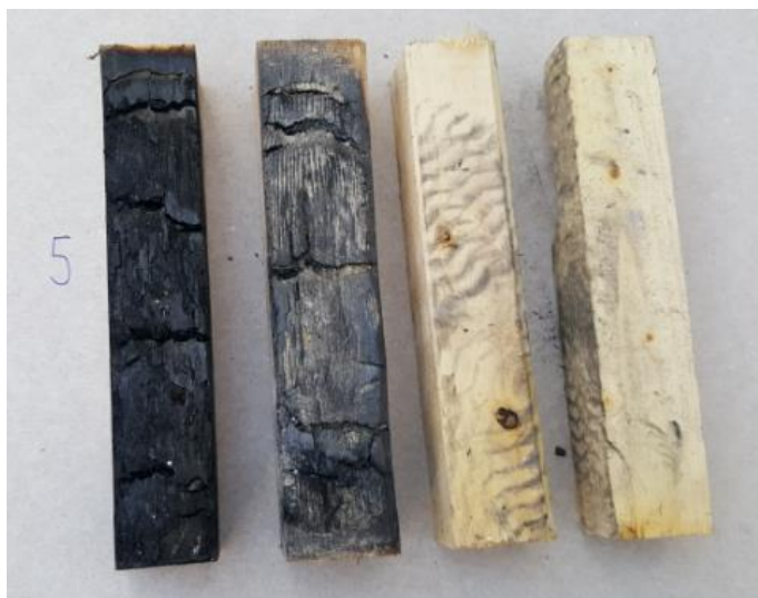
Figur 45 Prøvestykkets innfesting etter gjennomføring av 30 minutters forsøk
