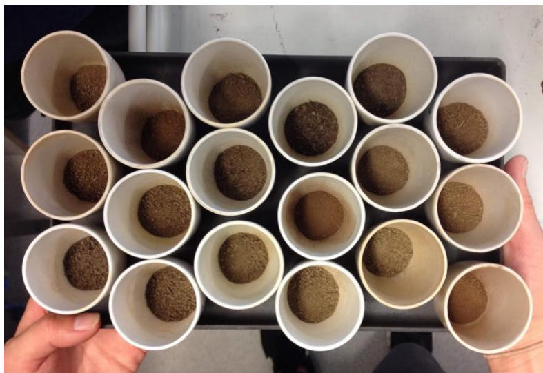
Figur 14: Brenning av jordprøver for utregning av jordas organiske innhold
