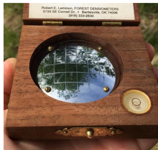
Figur 13: Densiometer med 24 ruter, brukt til å måle lystilgangen i analyserutene.
