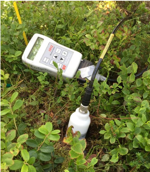
Figur 7. TRIME jordfuktighetsmåler. Fire målinger er utført i hver rute
