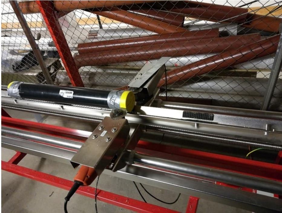
Figur 7: Illustrasjonsfoto som viser utstyret som ble brukt til å dele kjerneprøvene. Vinkelsliperne er fastmontert på skinner som kan beveges frem og tilbake. Kjerneprøven er plassert på en egen skinne i midten.
