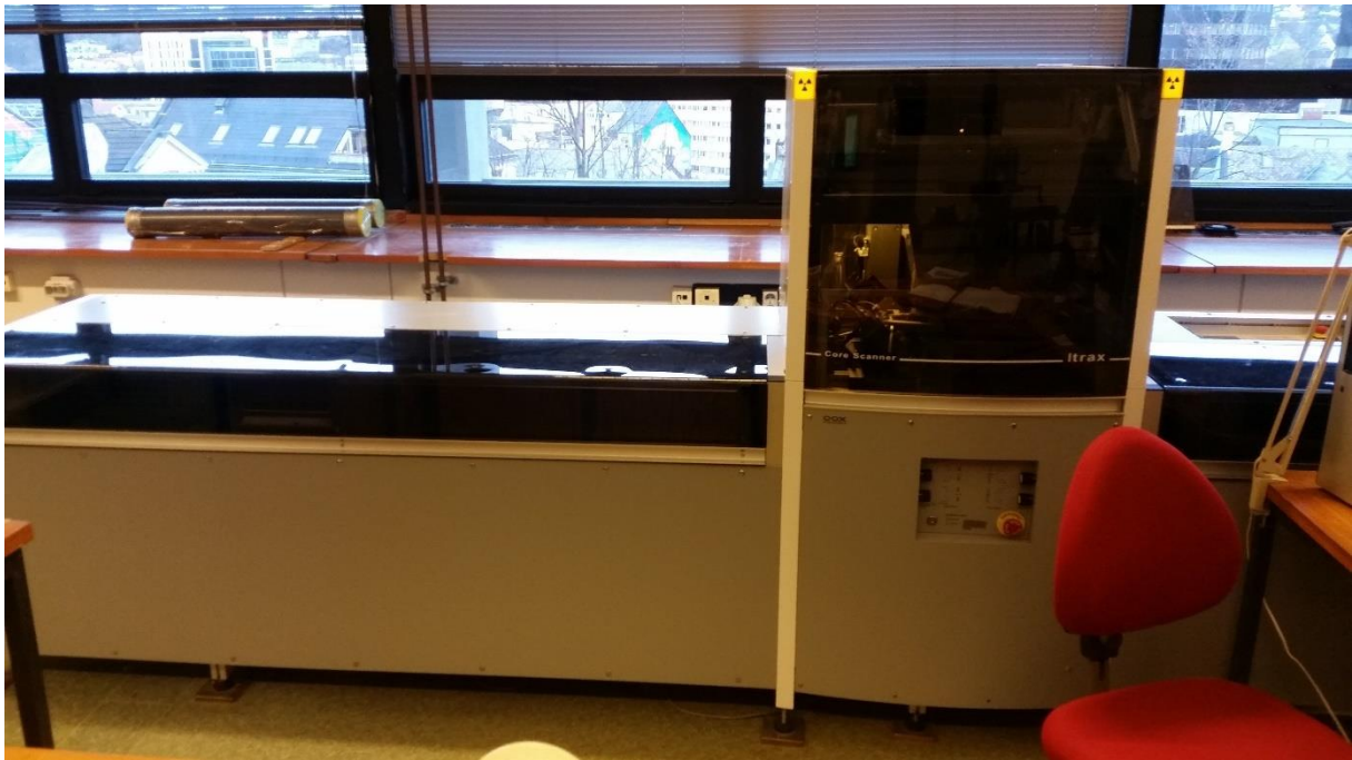
Figur 8: Foto som viser ITRAX kjerneskaner. Sedimentkjernen plasseres i kammeret til venstre, med toppen av sedimentene vendt mot sensorene. Sensorene er plassert i skapet i midten.
