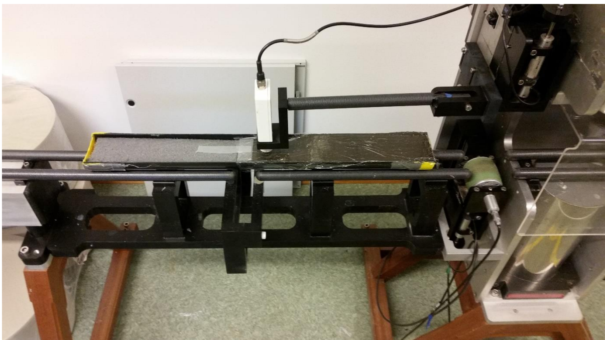
Figur 9: Foto som viser GeoTek multisensor kjernelogger. Sedimentkjernene plasseres med toppen av sedimentene vendt mot venstre.
