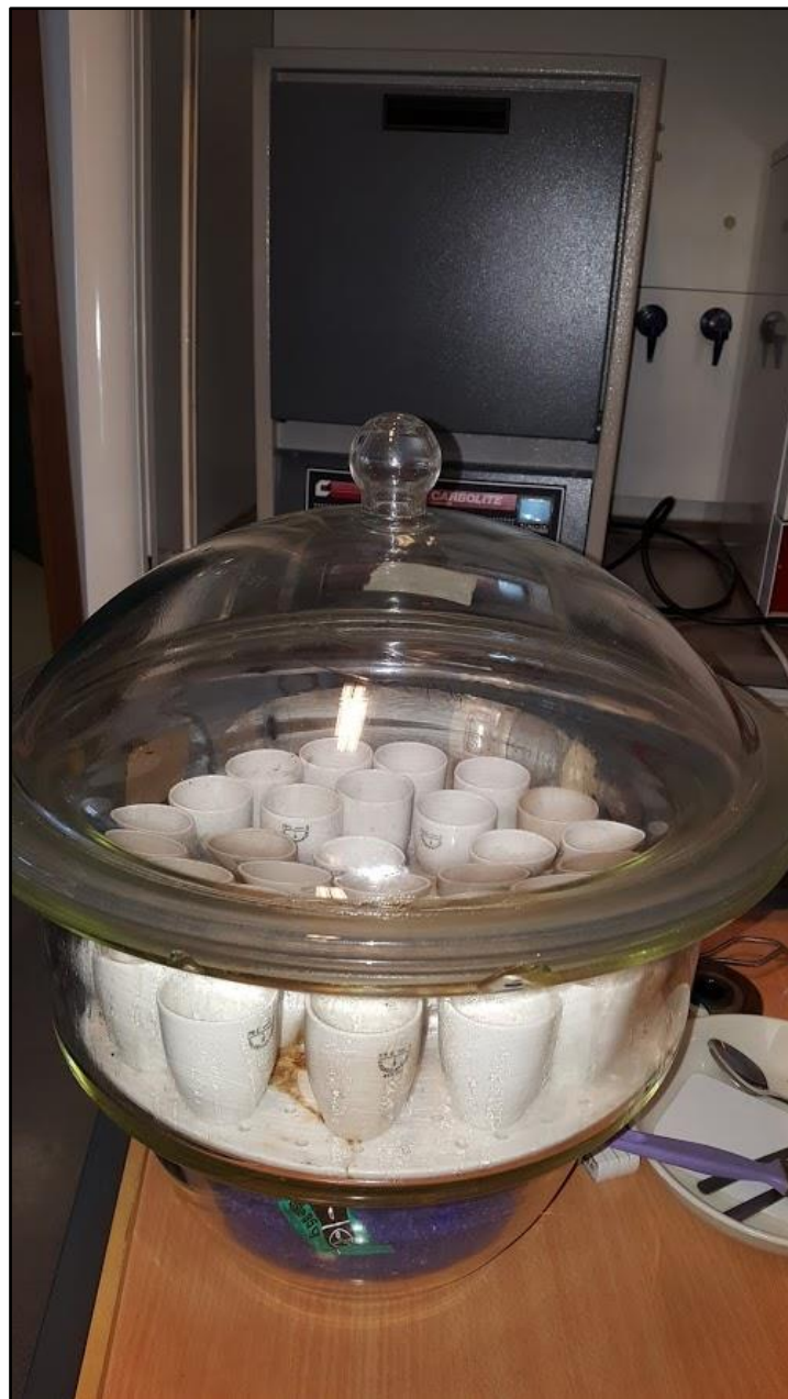
Figur 13. Eksikator for nedkjøling og tørking av sedimentprøven med ovnen i bakgrunnen. Foto: Jonas Kimerud.
