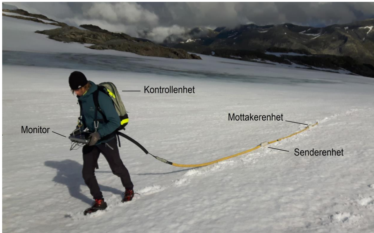
Figur 14: Georadar med 50 MHz antenne. Bildet ble tatt under feltarbeidet i september.
