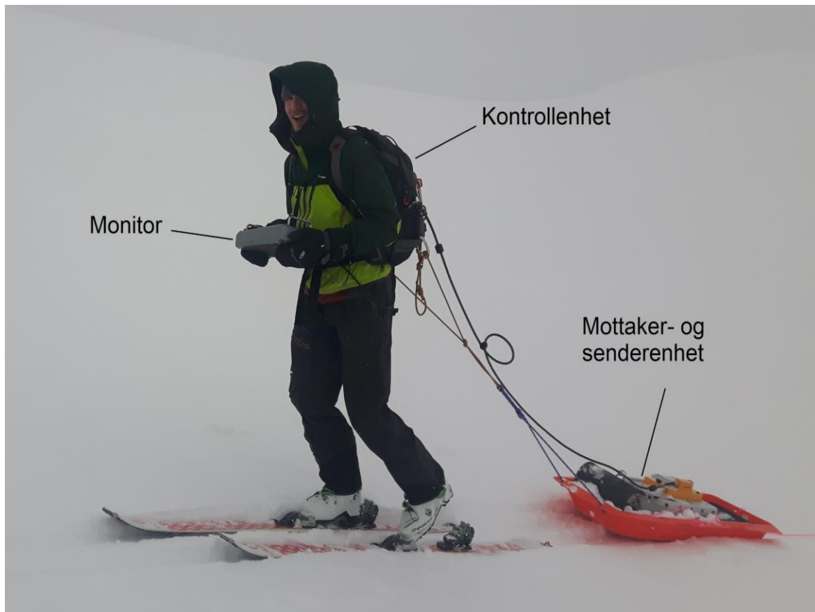
Figur 15: Georadar med 500MHz antenne. Bildet er fra feltarbeidet i februar.
