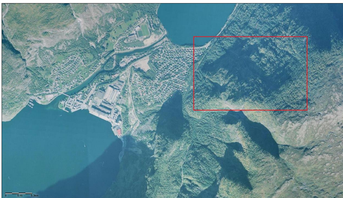
Figur 30 Området er godt vegetert, noe som er med å bidra til å stabilisere snødekket (Norge i bilder, 2018)
