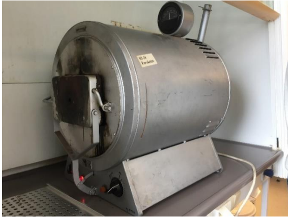
Figur 18: Heraus forbrenningsovn gel i bunn.
