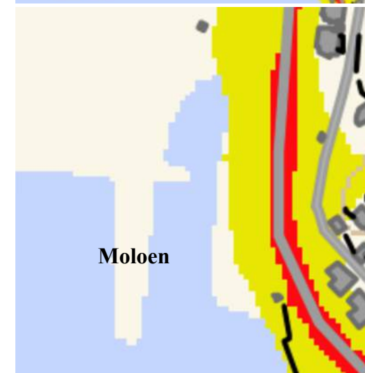
Figur 49 - Innzoomet utklipp av Figur 50 viser hvor stor del av friområdet på motsatt side av moloen som er i gul støysone (Statens vegvesen, 2017).
