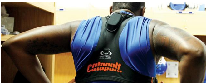
Bilde 1: Bildet viser vesten spelarane brukte under drakta i kamp. Sendaren var plassert i den vesle lomma øvst på ryggen.
