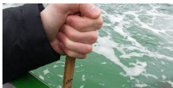
Figur 10: Vannstandsmåling med pinne markert hver 10 cm, til 120 cm.
