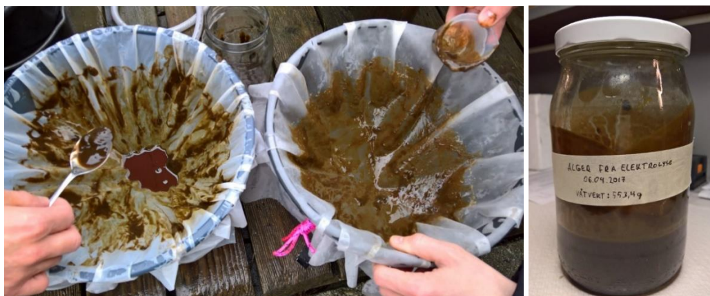
Figur 65: Forsiktig overføring av algene fra filtreringsbøttene til krukken. Ferdig våtvekt var på 553,4 gram.
