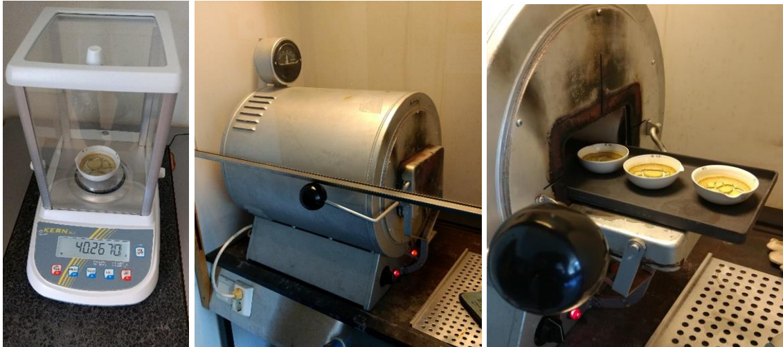
Figur 31: Veeining av tørrvekt (t.v.) og plassering av diglene i forbrenningsoven (i.m, t.h.)
