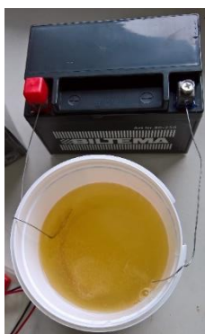
Figur 55: Mislykket elektroforeseforsøk, pga oksidasjon.
