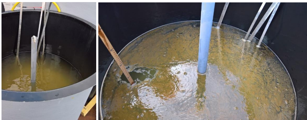
Figur 25: Elektroforese av sifonert algevann, etter 5- og 30- min med strømtilførsel.
