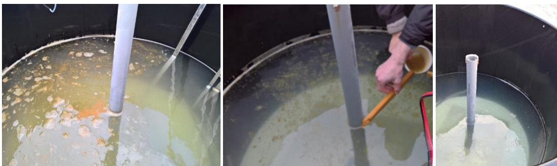
Figur 26: Bilder tatt etter 40- 70- og 90 min med elektroforese, etter henholdsvis 10- 40- og 60 min med algeinnsamling.
