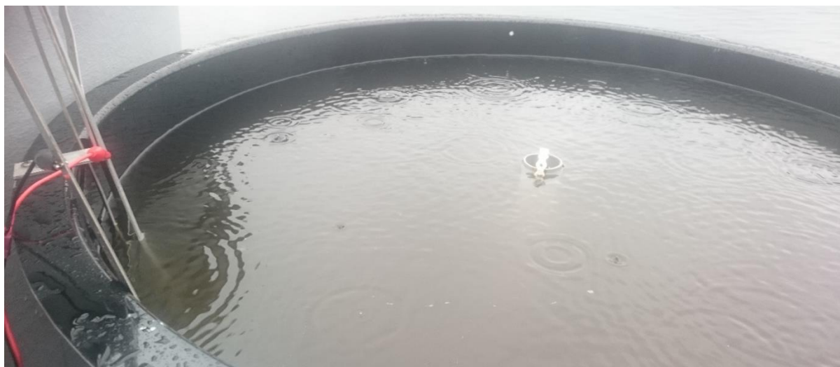
Figur 28: Elektroforesekaret fylt til randen, strømtilførselsklyper koblet til aluminiumstrimlene, samt avtagbart overflatesluk.
