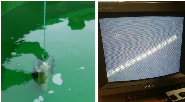
Figur 15: CTD måling i bunnen av karet, og mikroskopbilde av Skeletonema Costatum , fra inokuleringskulturen, som vist på skjerm. Bilde tatt 28.02.17.
