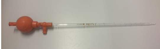
Figur 17: 3-veis pipette brukt for oppmåling av vannglass
