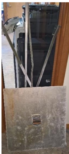
Figur 27: Aluminiums-platen og strimlene brukt i elektroforesekarret.
