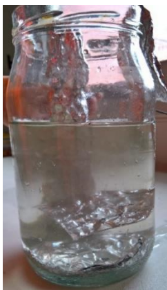
Figur 23: Strimler av aluminiumsfolie, koblet til strømforsyning, senket i glasskrukke.
