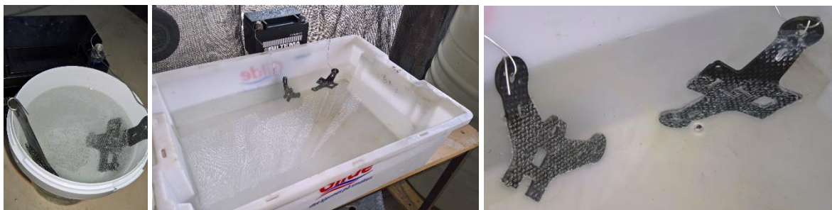
Figur 56: Elektroforeseforsøk med 12V batteri og karbonbiter fra en ødelagt drone. Observasjon av tynt hvitt belegg.
