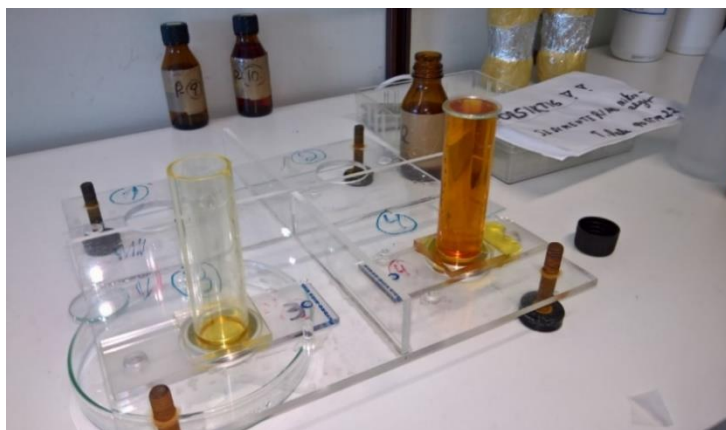
Figur 29: Foran: Sedimentering av vannprøve i 50 ml rør. Bak: vannprøveflasker.
