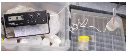
Figur 8: PH målinger tatt med et pH-meter.
