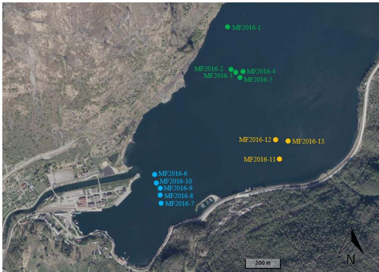
Figur 9: Figuren viser stasjonene i Indre Aurlandsfjord hvor sedimentkjerner med intakt sediment-vann overgang ble hentet. Bildet er hentet fra http 12 .
