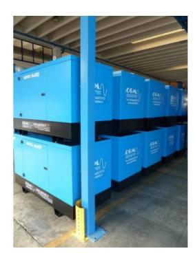
Acier, peinture par poudre RAL5015, pour assurer une optimale résistance à la corrosion. Matériel acoustique résistant au feu, avec atténuation acoustique élevée.
