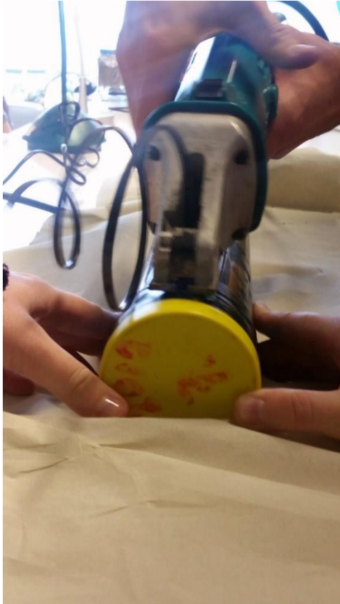
Figur 3.6: Prøven åpnes med blikksaks modell JS 1660
