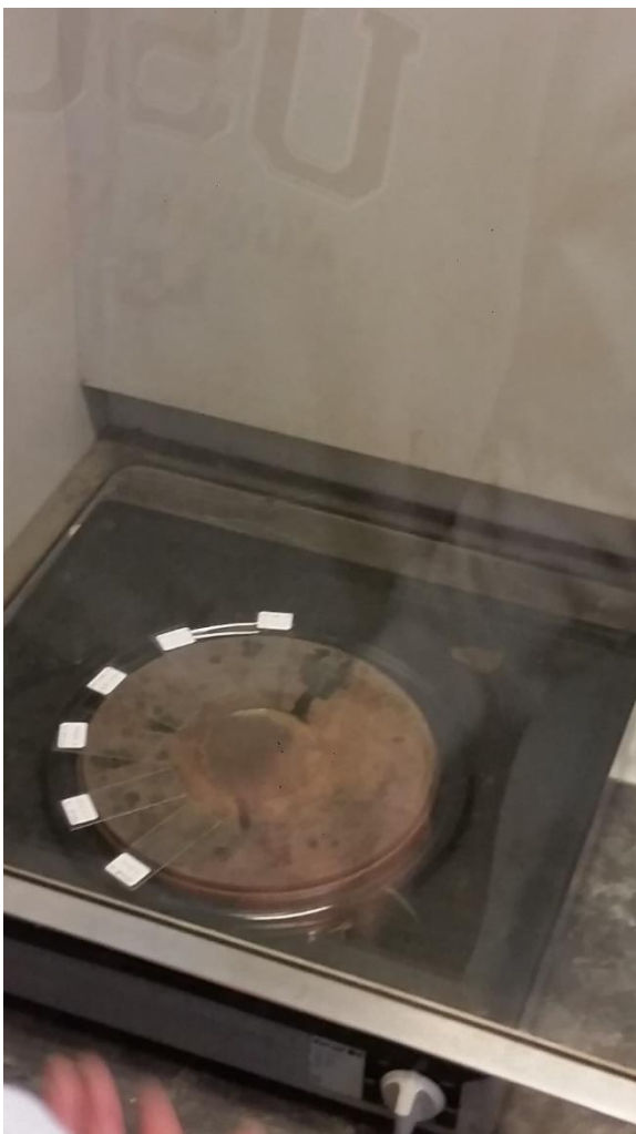
Figur 3.7: Seks merkete dekkglass ligger klare på kokeplaten for å limes sammen til smørepreparatene
