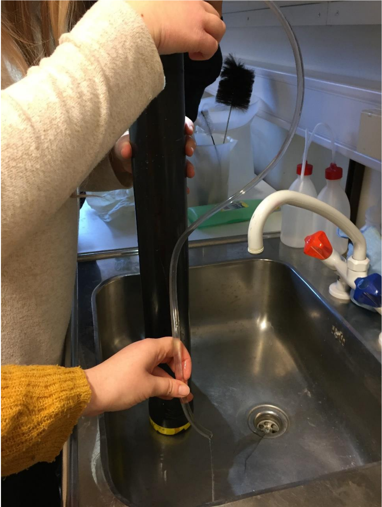
Figur 3.3: En hevert fjerner vannet i øverste del av prøverøret
