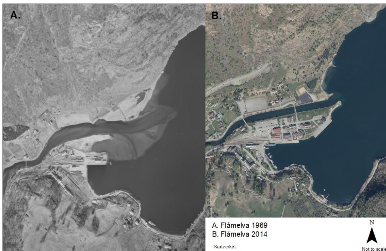
Figur 1.8. A: Flybilde fra 1969 over deltaområdet til flåmselva før kaiutbygging i 1985. © Kartverket (1969) B: Flybildet fra 2014 over dagens Flåm etter utfylling og ferdigstilling av kaianlegget. © Kartverket (2017)
