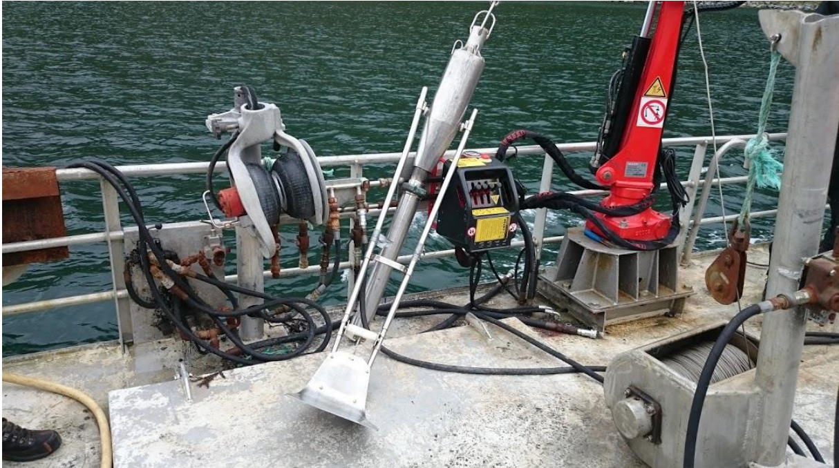
Figur 3.2: Stativ for kjerneør. Rørene ble plassert på stativet og senket ned i sedimentene
