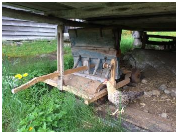
Figur 31: Sådybden kan reguleres med håndtaket.
