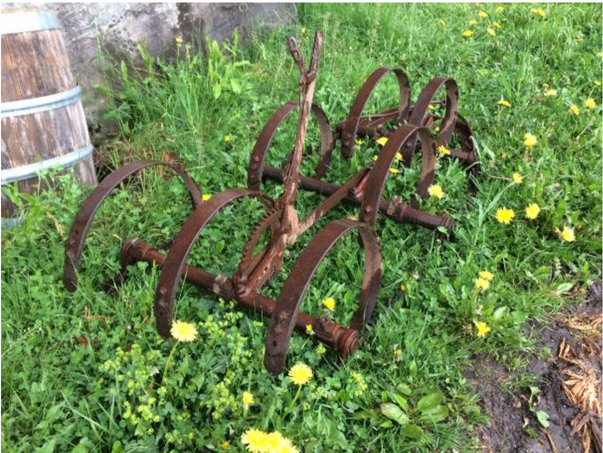
Figur 29: Håndtaket brukes for å vende tindene 180 grader rundt, slik at de står ned i jorda under harving.
