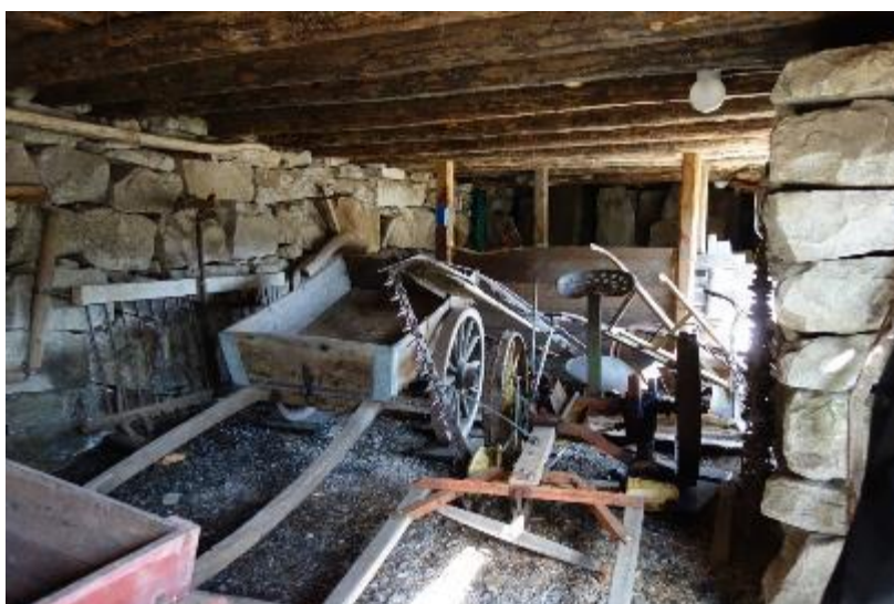
Figur 19: Knivene som stikker opp til venstre på maskina legges ned mot marka når man slår. Til venstre for såmaskina står ei møkkjerre.
