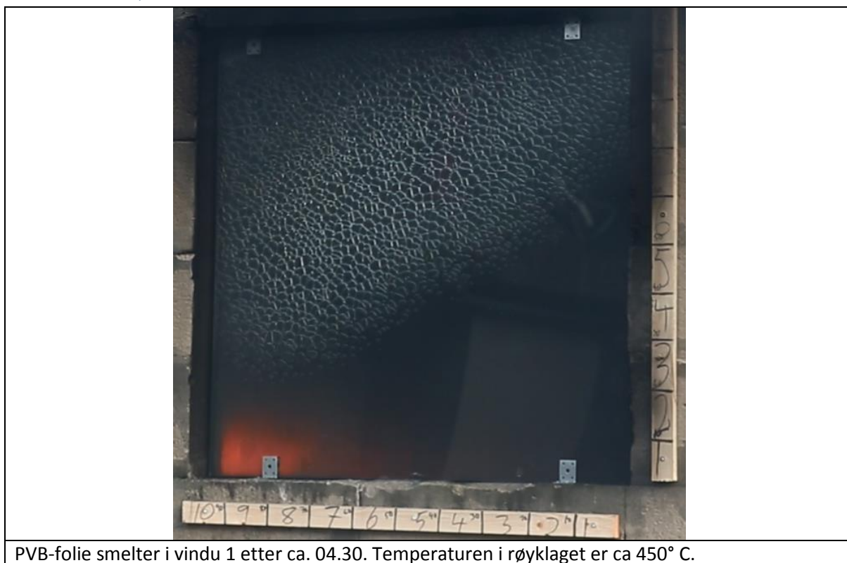
Bilde 2: Forsøk 1 - Vindu 1 - PBV-folie smelter
