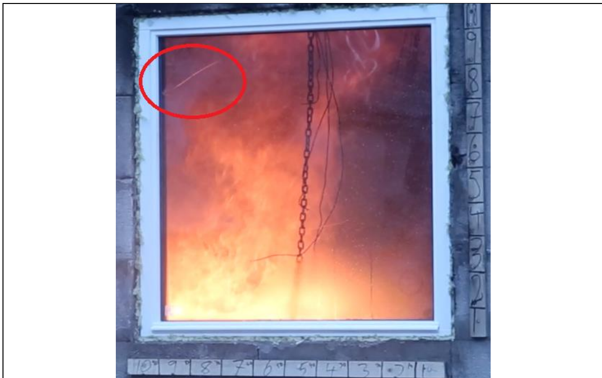
Bilde 11: Forsøk 3 - Vindu 1 – indre glass knuses
