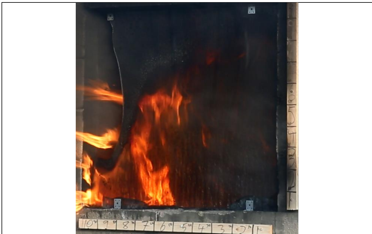
Ytre glass, vindu 1, sprekker og knuses etter ca. 15.30. Temperaturen i røyklaget er ca 620° C.
