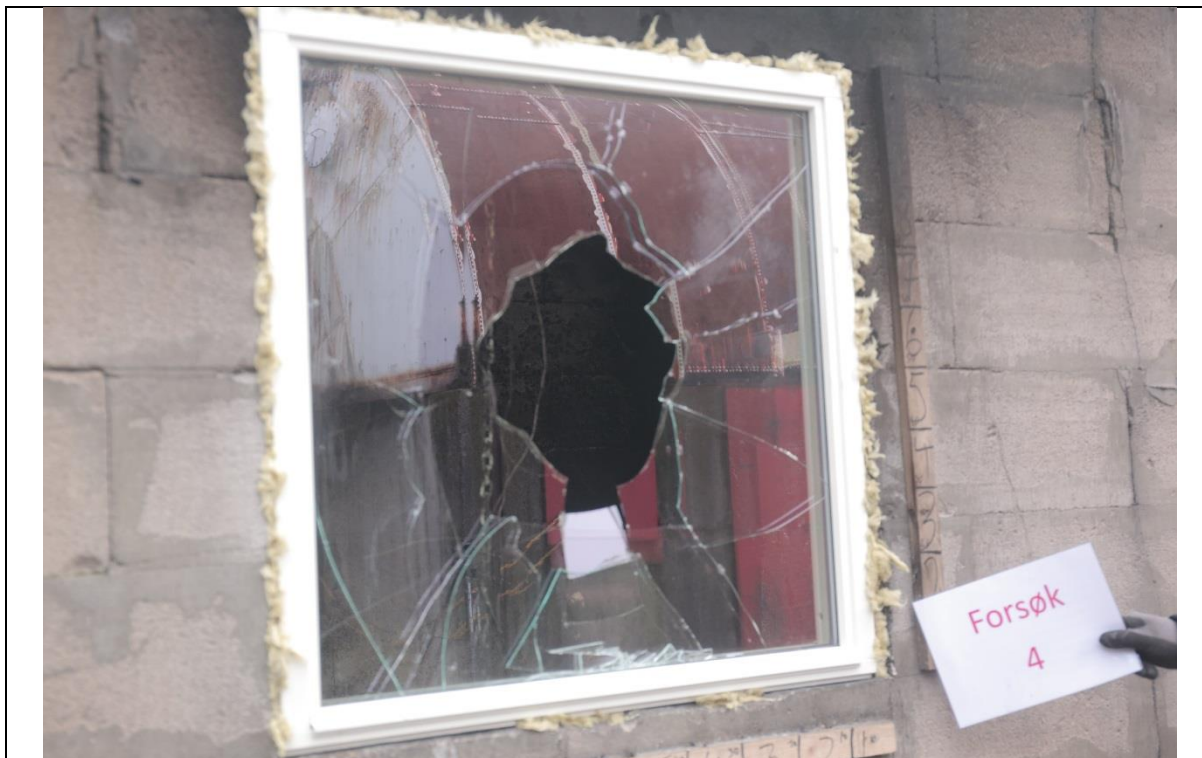
Vindu 1 før antennelse. Glassene er knust med hammer.
