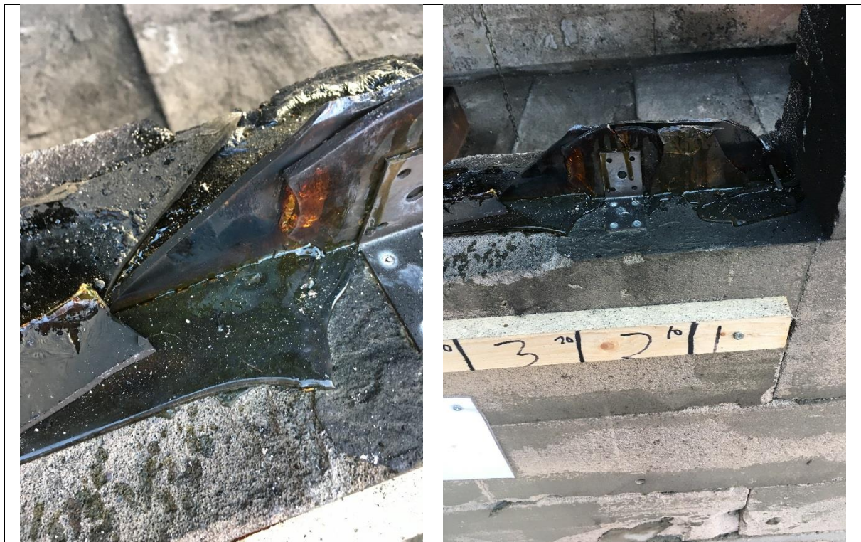
Forsøk 1 – Vindu 1 – Smeltet PVB-folie etter brann
