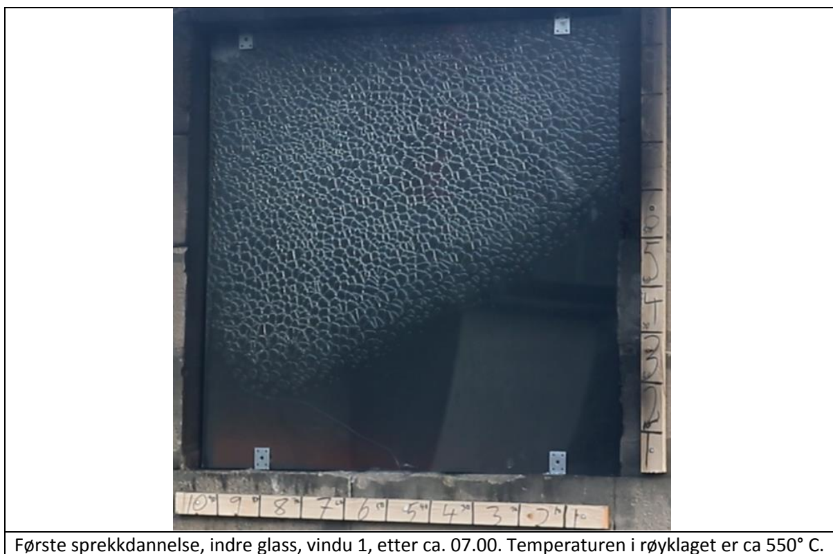
Bilde 3: Forsøk 1 - Vindu 1 - Første sprekkdannelse, indre glass
