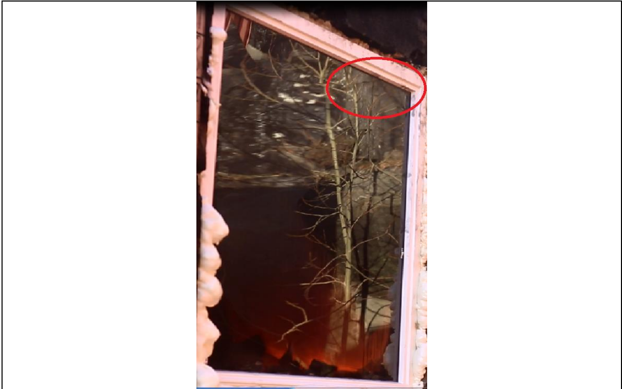
Bilde 9: Forsøk 2 – Vindu 2 – førset sprekkdannelse ytre glass
