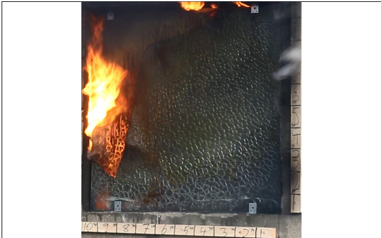
Indre glass, vindu 1, knuses etter ca. 13.30. Temperaturen i røyklaget er ca 600° C.
