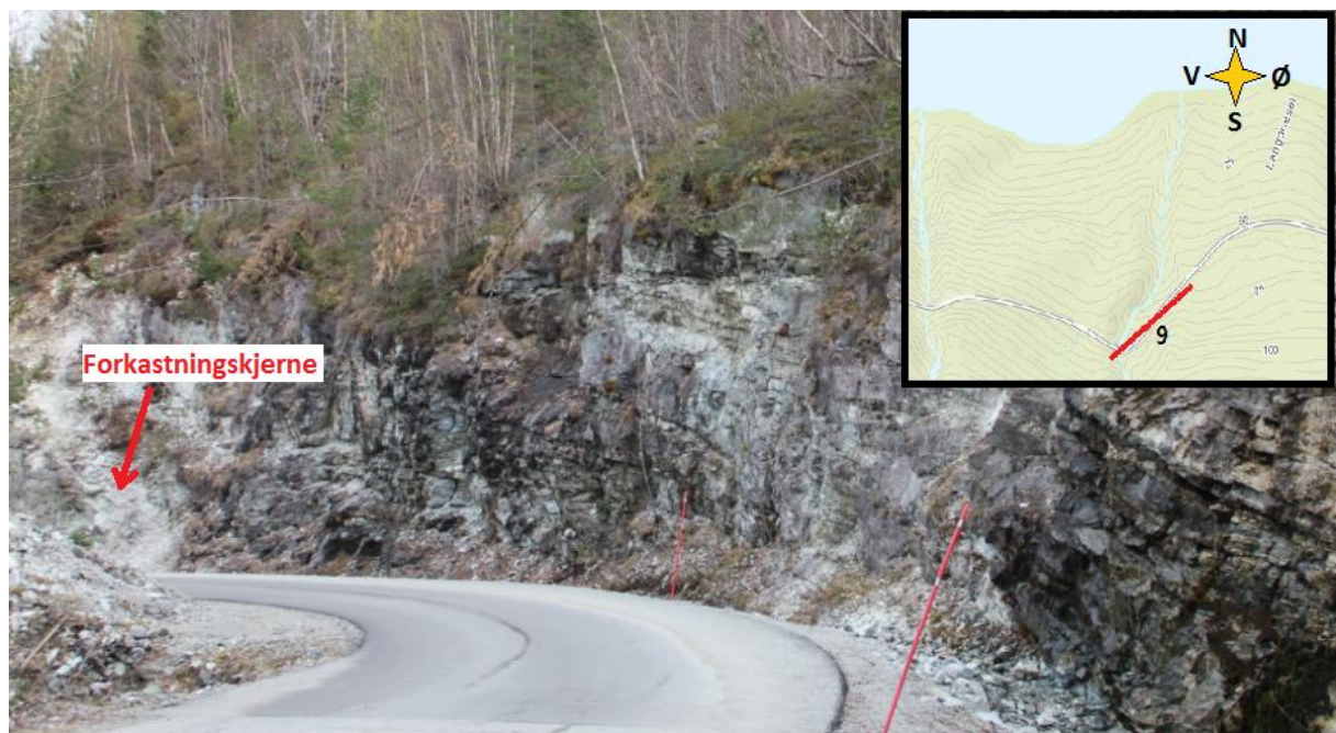
Figur 4.1.9: Mogleg normalforkastning frå felt danna i forbindelse med kollaps av den kaledonske fjellkjeda.
