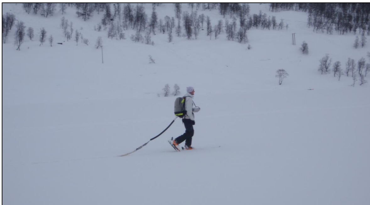
Figur 14: Fotografi fra feltarbeidet i Mars 2016. Antennen blir dratt bak en person på ski med kontrollenhet-sekken på ryggen. Foto: Simen Norheim
