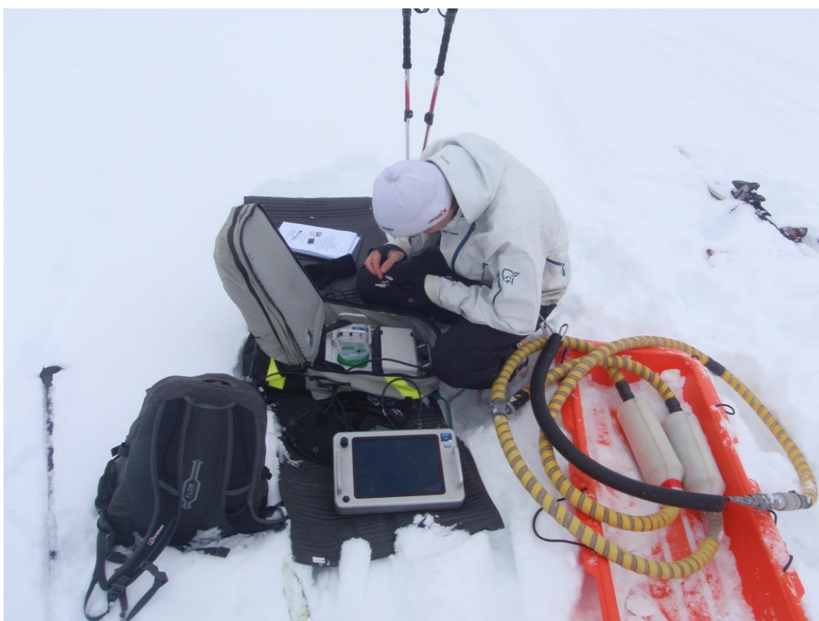
Figur 13: Oppsetting av georadar systemet fra "Malå" bestående av "ProEX Control Unit" og "XV monitor" og RTA.
