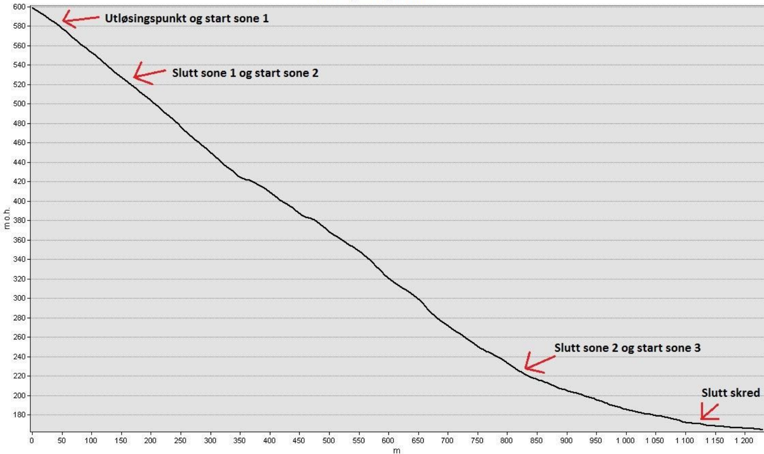
Figur 5.24 viser terrengprofil av skredhendelsen 10. juni 2011. De røde pilene viser til soneinndelingen av skredet.
