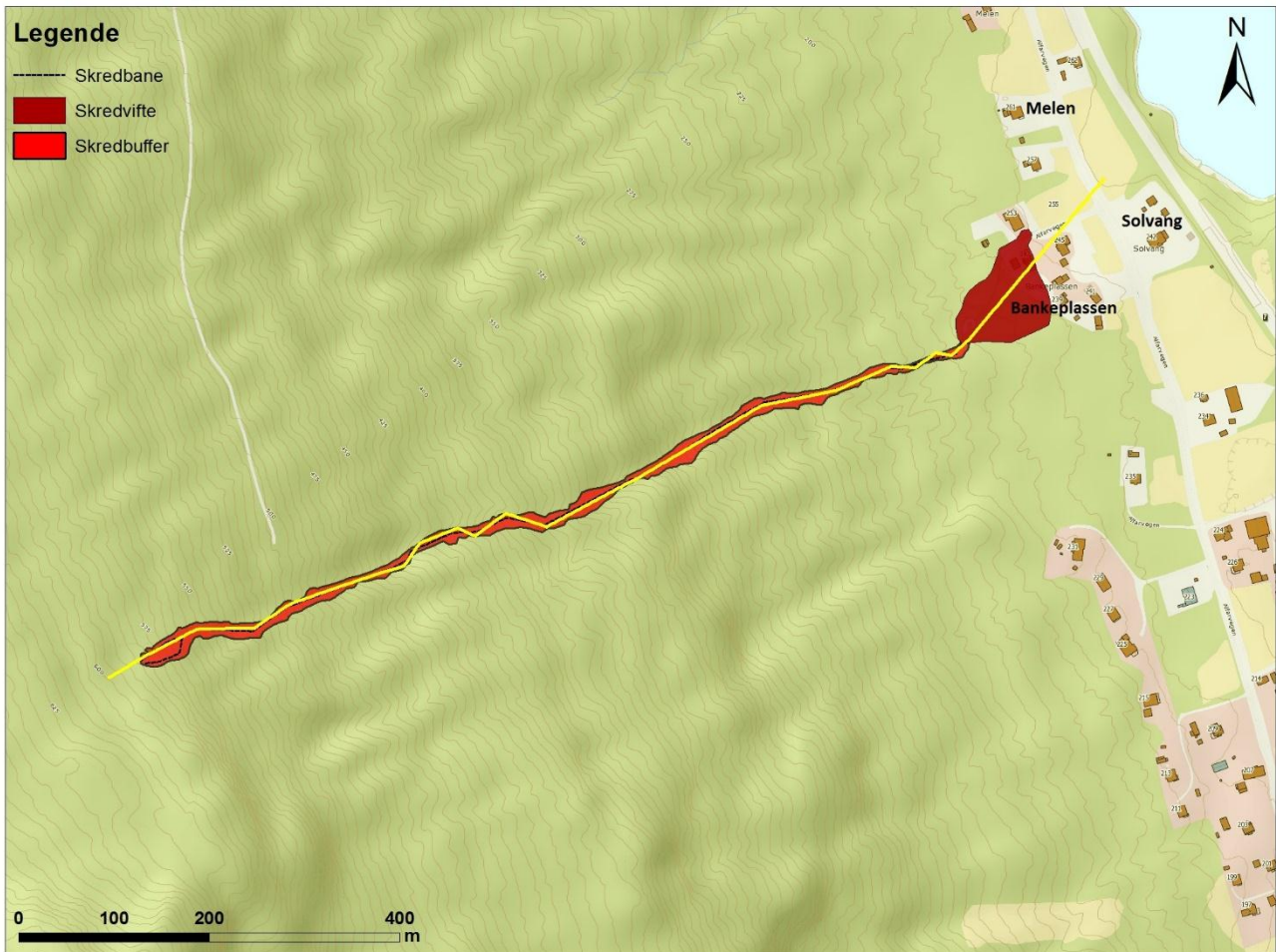
Figur 5.23 Plassering av skredet ved Alfarvegen. Den gule linjen er profil linjen brukt for å lage terrengprofil og helningsprofil. Skredbuffer tilsier skredbanens bredde.
