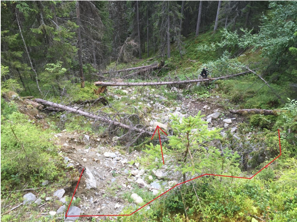
Figur 5.10 viser utløsningspunktet for skredhendelsen 9. juli 2007 ovenfra. Den røde streken viser begynnelsen på skredet og pilen viser retningen skredet tok. Foto: Renate R. Johansen
