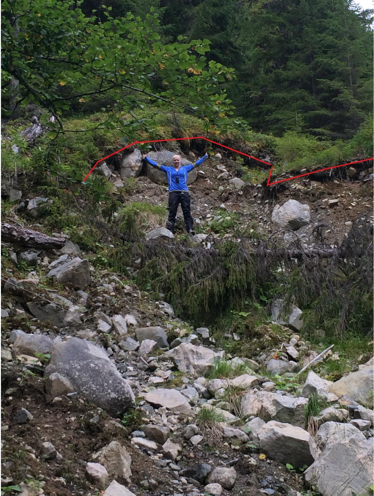
Figur 5.11 viser utløsningspunktet for skredhendelsen ved Smedsgården nedenfra. Den røde streken viser utløsningspunktet. Massene i utløsningspunktet er tydelig morene med steiner og blokker. Målestokken (personen) på bilde er 174cm. Foto: Oda K. Delbeck
