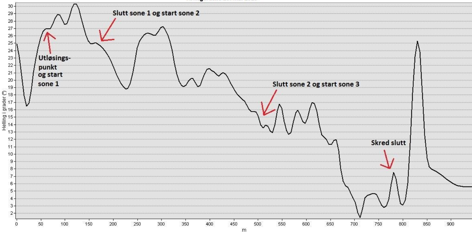
Figur 5.45 viser helningsprofil av skredbanen til skredhendelsen 23. mai 2013 i Arnegårdslie. De røde pilene viser soneinndelingen av skredbanen.
