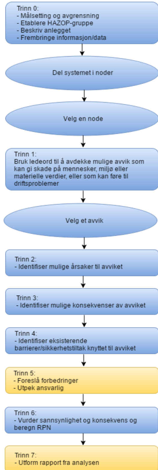
FIGUR 7: FLYTSKJEMA FOR HAZOP (LAGET I DRAW.IO)
