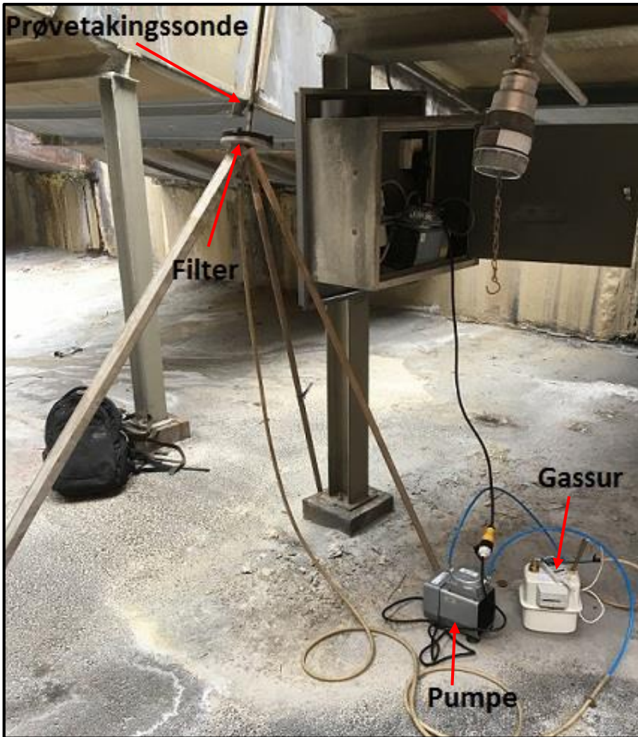
Figur 7-2: Alt utstyret montert og klar for støvmåling
