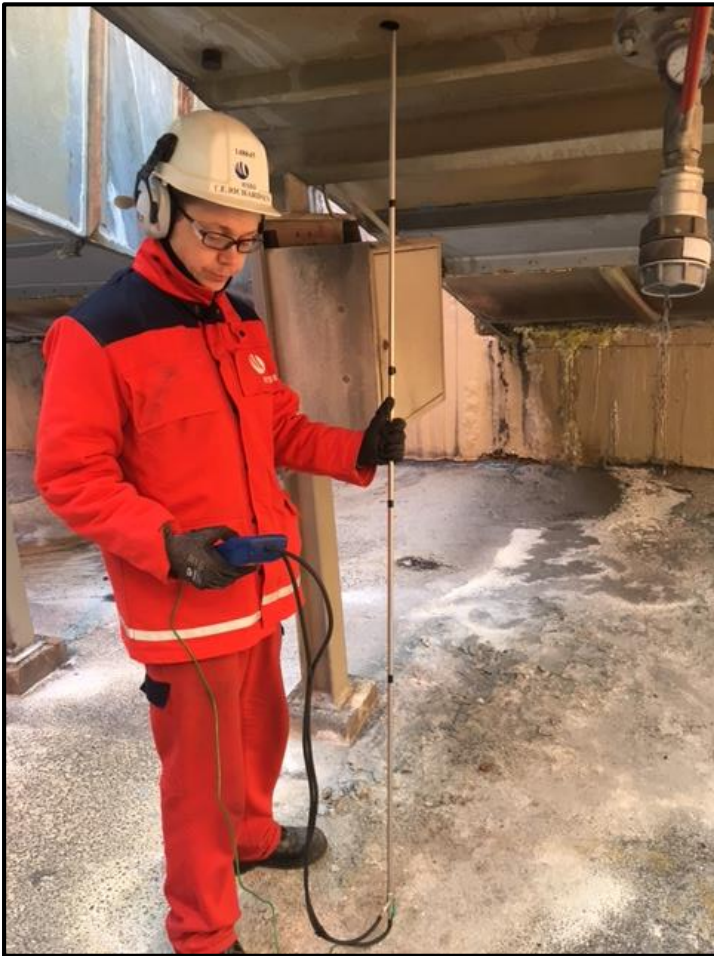
Figur 5-1: Ekstern veileder måler hastighet ved hjelp av pitotrør
