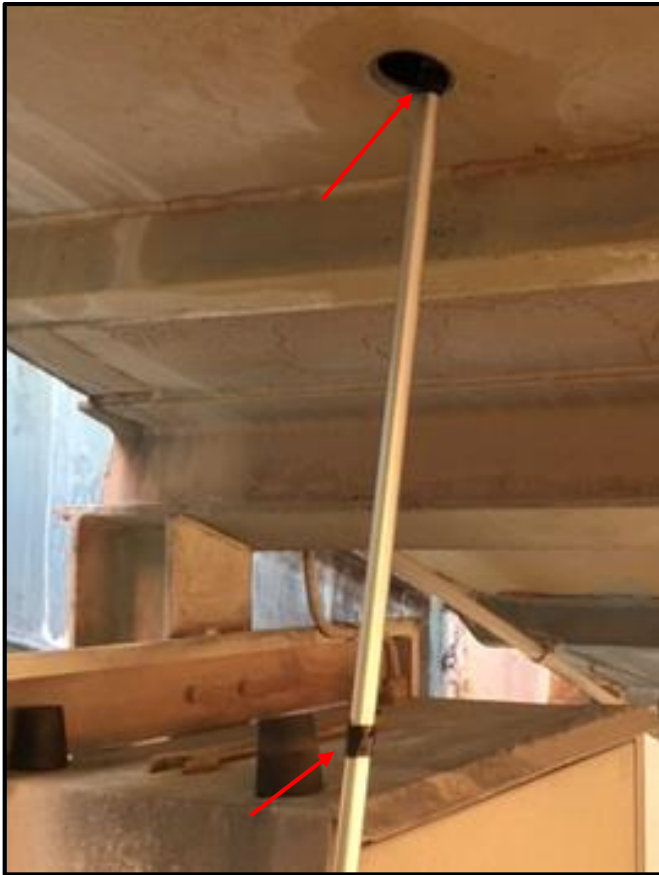
Figur 5-9: Pitotrør markert med teip for posisjonering av målepunktene langs y-aksen
