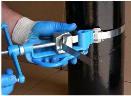
FIGUR 4-12 STÅLBÅND MED STRAMMER (BAND-N-GO INC., 2016)
