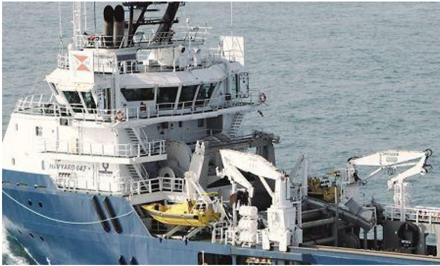
Figur 2.16 Jibb-kran på skinner, Palfinger Group [16]
