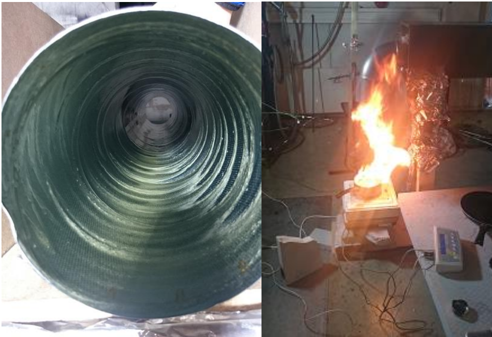
Figur A15. Bildet til venstre viser innsiden av røret innsmurt med formfett. Bildet til høyre er underveis i forsøket.
