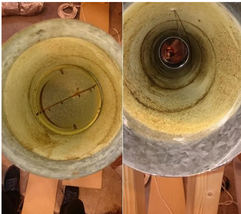
Figur A1. Brukte spirorør før forsøkene.
