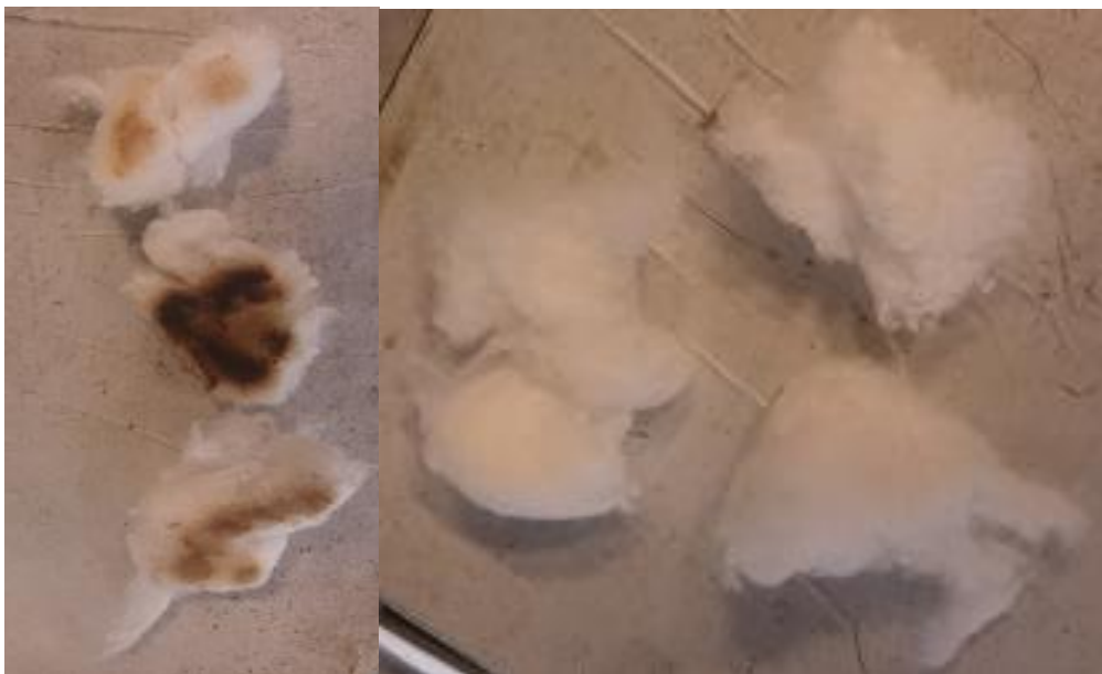
Figur 24. Bilder av bomull etter forsøk med heptan i røret.
