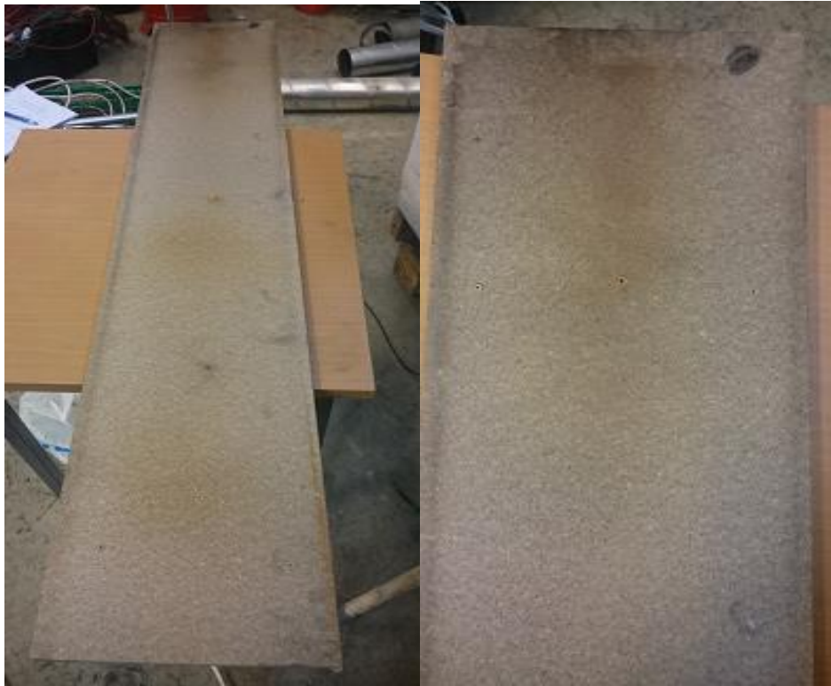
Figur 26. Bilde av øverste sponplate etter forsøk med heptan.
