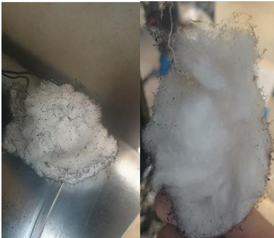
Figur A16. Bomullsdotten på toppen av røret nærmest kasserollen. Bildet til høyre viser undersiden som var i kontakt med røret, og viser tydelig at det svarte er sot fra brannen på komfyren.
