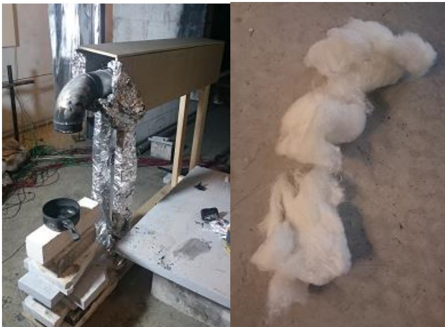
Figur A18. Bomulldottene til høyre var plassert på toppen av røret i begge forsøkene, og hadde ingen antydning til merke.
