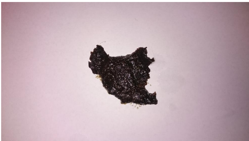
Figur 9. Fett samlet fra overside av ventilator fra storkjøkken.
