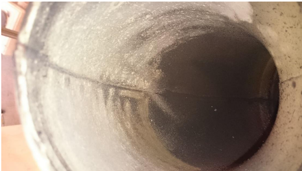
Figur A14. Innsiden av 90 graders røret etter forsøket
