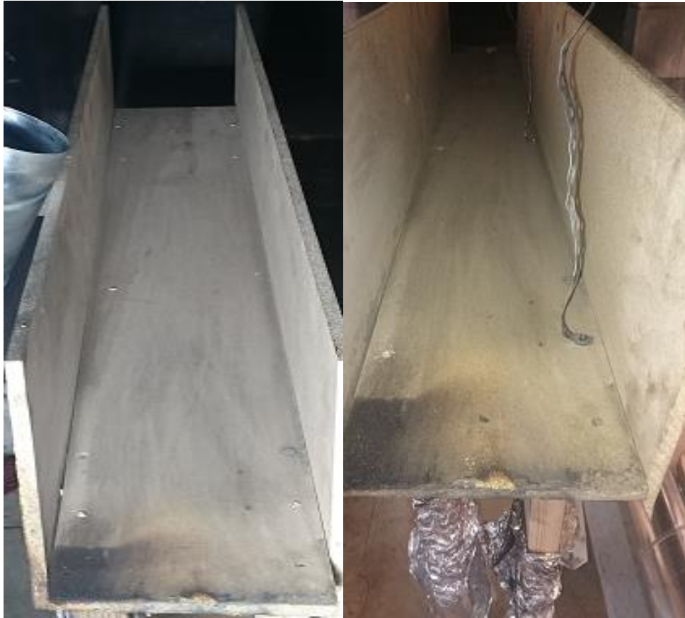
Figur 23. Bilder av riggen før og etter forsøk med heptan.
