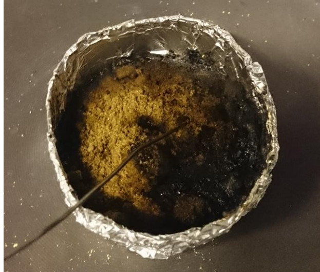
Figur 10. Oppvarming av fett fra gamle avtrekkskanaler i leiligheter.
