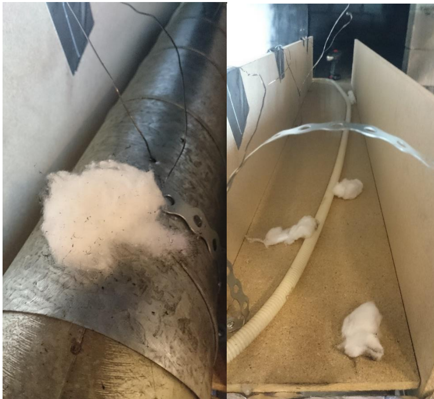
Figur 18. Bilder av riggen etter forsøket med spirorør med fettbelegg på innsiden.
