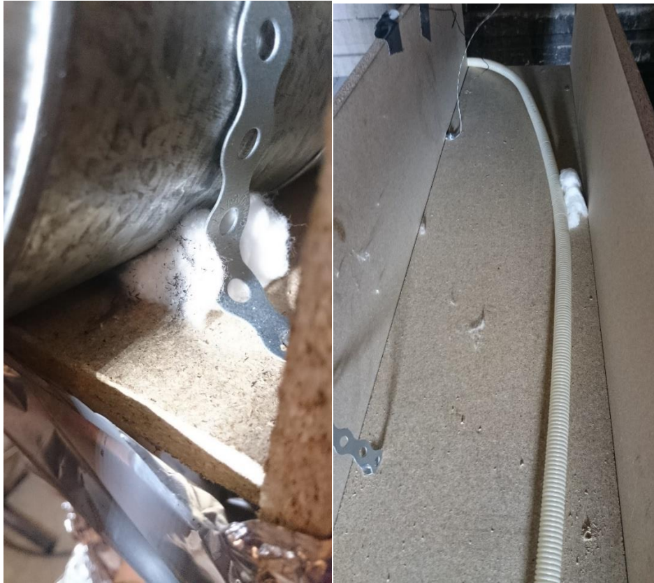
Figur A13. Rigger etter forsøket. Det svarte på bomullet til venstre er sot fra brannen på komfyren.
