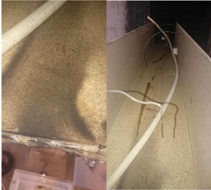
Figur A17. Bildetne er tatt av riggen etter forsøket. Det mørke på bildet til venstre er sot fra selve flammeforbrannen. Merkene på sponplata i bunn på bildet til høyre er gris fra fette i røret når det ble tatt vekk.
