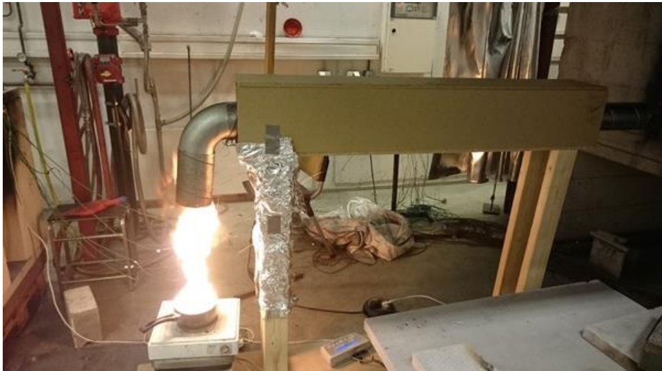
Figur A7. Underveis i forsøket med brukte spirorør med 1 dl solsikkeolje i kasserollen.
