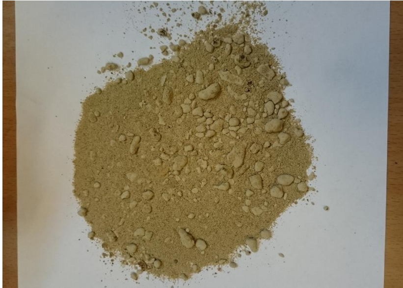
Figur 8. Fett skrapet av innsiden fra flere forskjellige brukte avtrekkskanaler.
