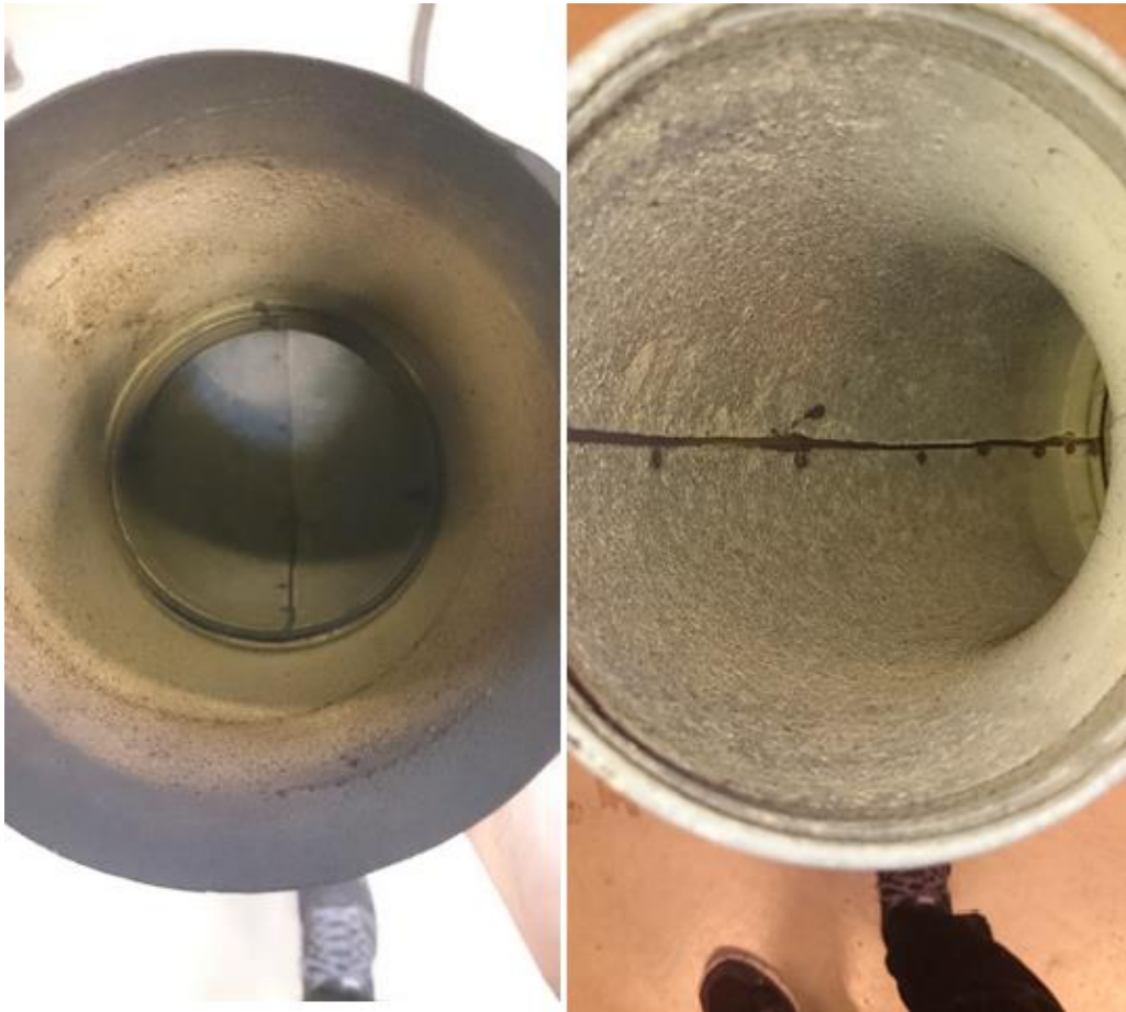
Figur A9. Innsiden av 90 graders røret etter forsøket.
