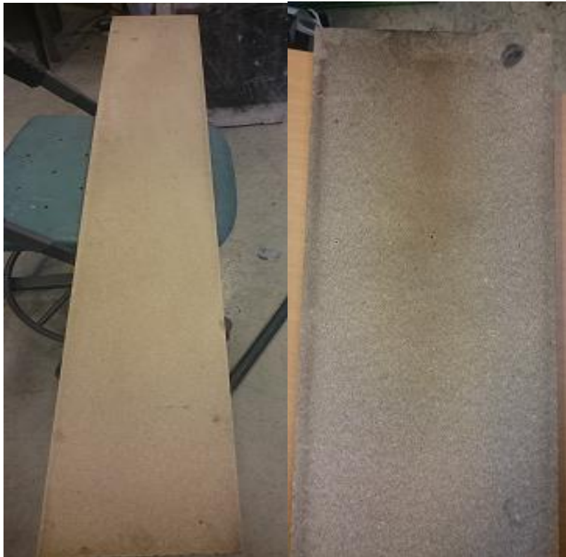
Figur A19. Bilder av den øverste sponplata etter forsøket. Ser antydning til noen svimerker.
