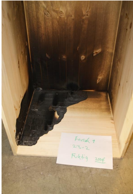
Figur G. 3 Rommet med 15,08 % fuktinnhold etter gjennomført forsøk.
