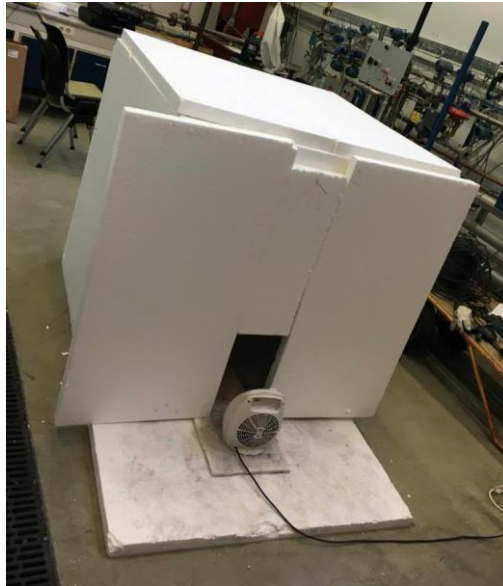
Figur 7 Tørkerom med plassering av vifte (konstruktør: Torgrim Log).
