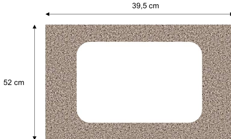
Figur E. 2 Limtreplaten med mål.
