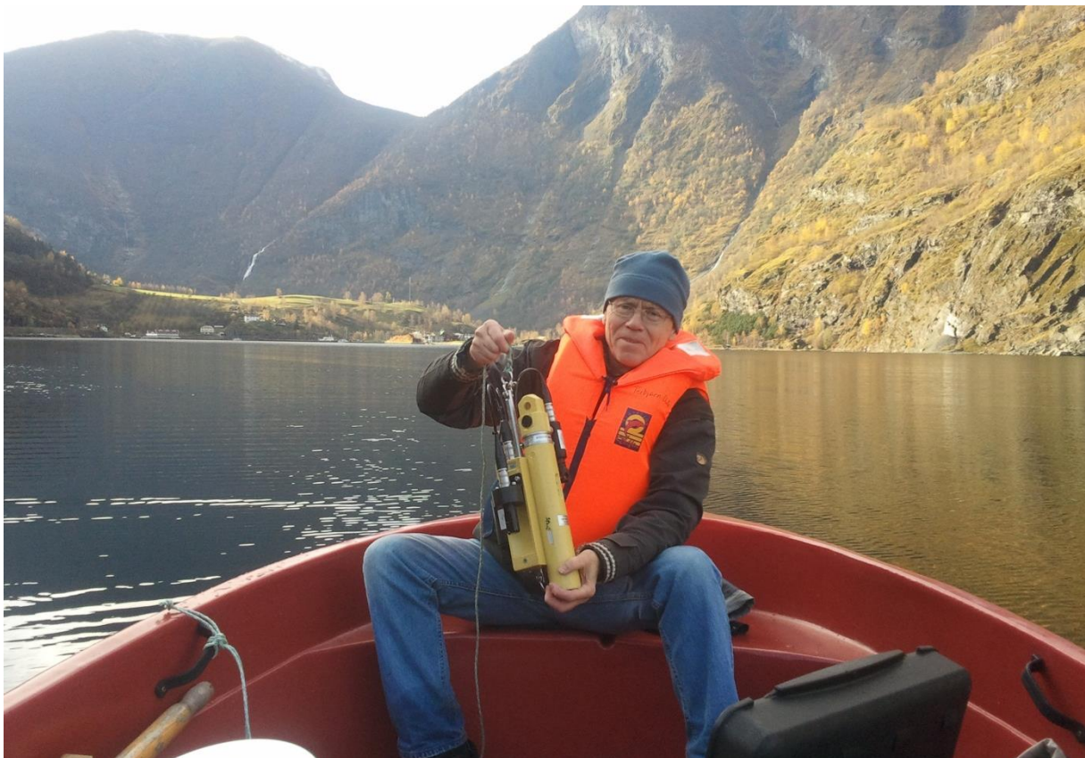
Fig. 8 Bilde fra målingene 25.10.2013 som viser Torbjørn Dale med STD-en klar for dybdeprofilering.
