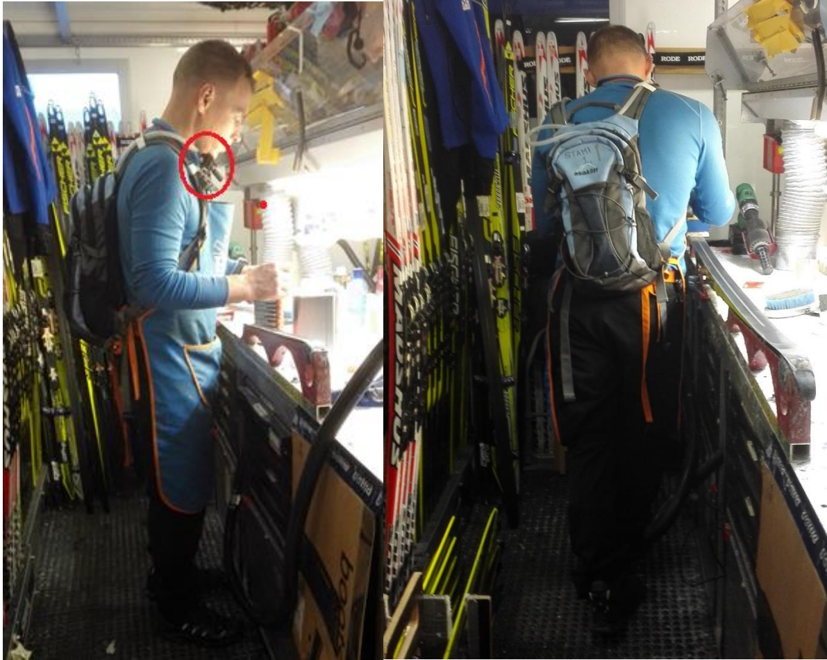
Figur 10 og 11: Her ser vi en skismører i hoveddelen utstyrt med personlige eksponeringsmålinger, mens han arbeider med glidsonene på en langrennsski.
