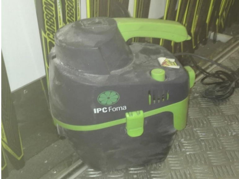
Figur 5: Her ser vi støvsugeren som brukes til avtrekk på hvert smørejern.
