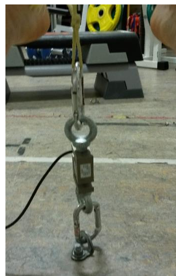
Kraftcella i bruk
