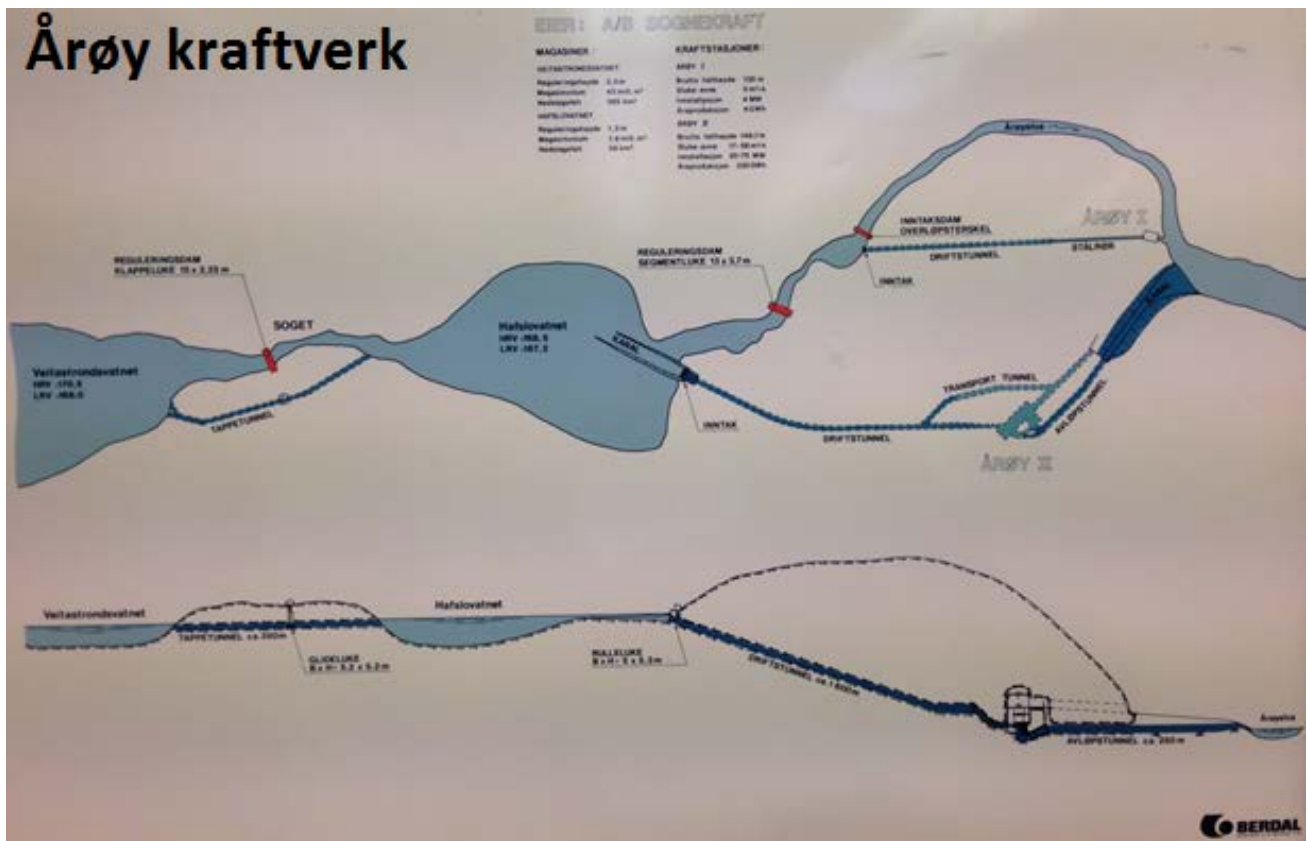
Figur 2: Oversiktskart over inntakene til Årøy vannkraftverk. Øverst er det sett ovenfra, under ser man det som er vertikalt snitt. Det blå området i midten er innsjøen Hafslovatnet med inntak til høyre ende. Tunellen går fra inntaket via kraftverket og ut i nedre del av Årøyelva. Det tørrlagte elveleiet er vist oppe i høyre hjørne. I tverrsnittet er det vist hvordan vannmagasinene er senket og hvor inntaket er plassert. Bilde er tatt fra informasjonstavle i Årøy kraftverk.
