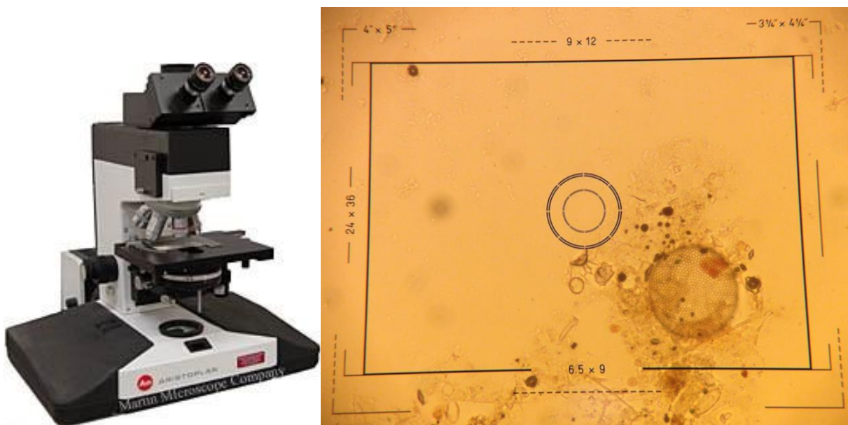
Figur 10 Bildet til venstre viser et Leitz Aristoplan Trinocular Phase Contrast Mikroskop som ble brukt under analyseringen av smørepreparatene ( http2 ). Bildet til høyre viser det innerste rektangelet som ble brukt som mal for tellingen.
