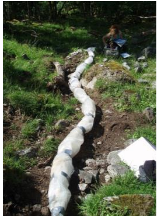
Figur 6. Georadarantenne pakka inn i bobleplast med sølvteip, til vern mot skit og slag. Bilete er ifrå starten av profilet, like under rotpunktet til Palvifta. Terrenget er ulendt med blokker i overflata, kratt og skog.
