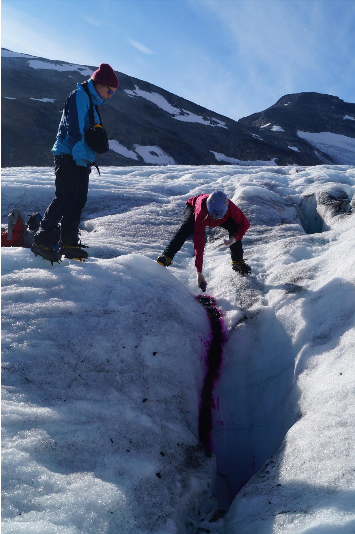
Figur 17. Lav vannføring i brønnen gjør det vanskelig å skylle fargebeholderen ordentlig. Foto: Marianne K. Sundal.
