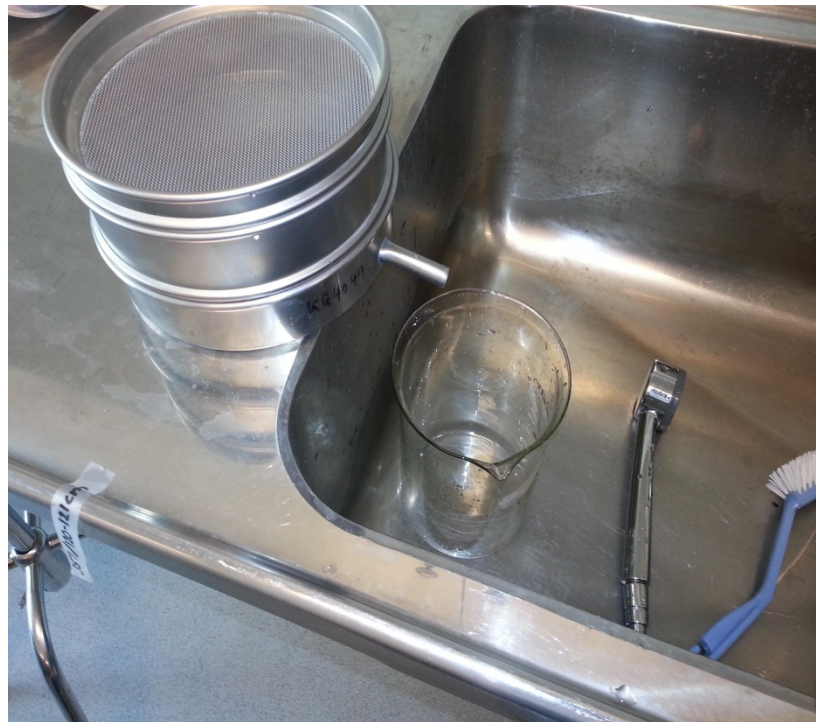
Figur 5.4 Instrument brukt til våtsikting, bestående av 3 deler. Sikt med 1 mm diameter øverst, og 63 \mu\text{m} i midten. Nederste del samler opp vannet med sediment <63 \mu\text{m} i et begerglass.
