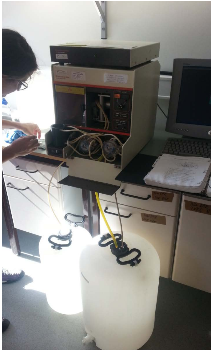
Figur 5.6 Sedigraf er et instrument som bruker mekaniske analysemetoder
