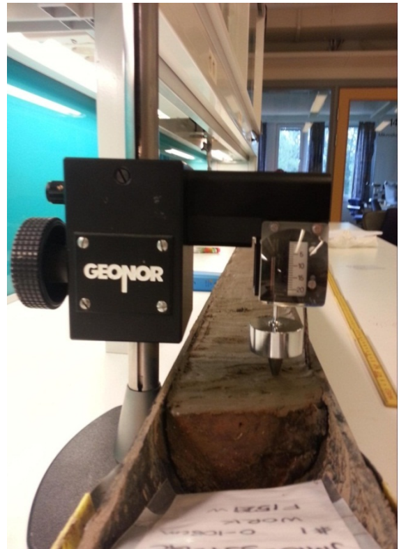
Figur 5.8 Konusapparatet i aksjon på 357
