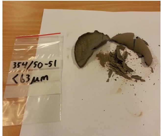
Figur 5.5 Materiale <63 \mu\text{m} skrapet ut av begerglass.
