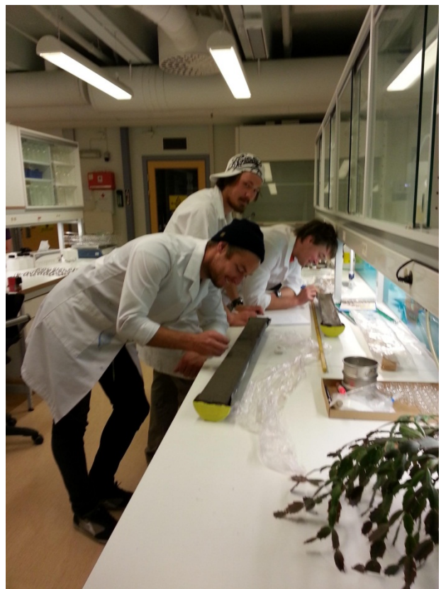
Figur 5.3 Visuell beskrivelse av kjerneprøver, utføres av studenter.
