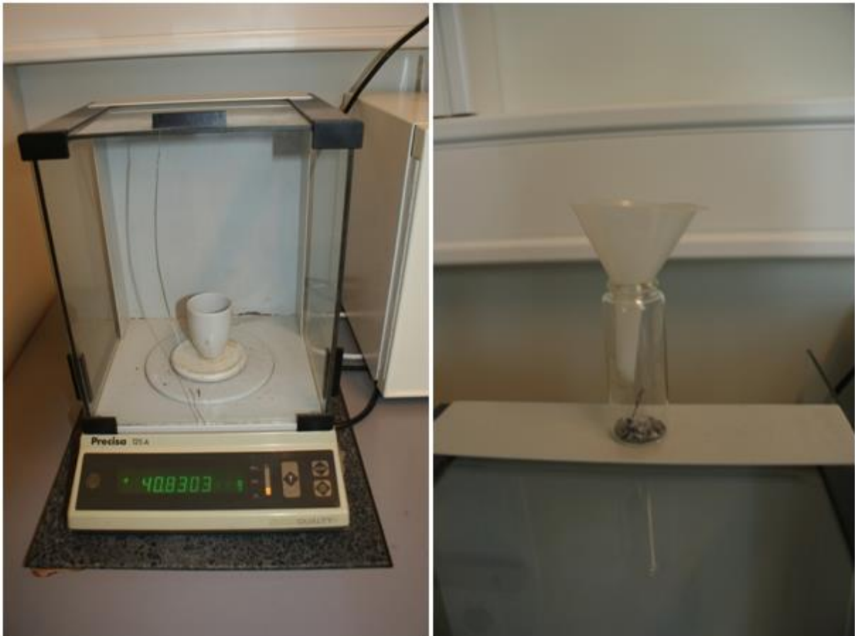
Figur 20: Veiing av askevekt og overføring av asken til 20ml glassbeholder.
