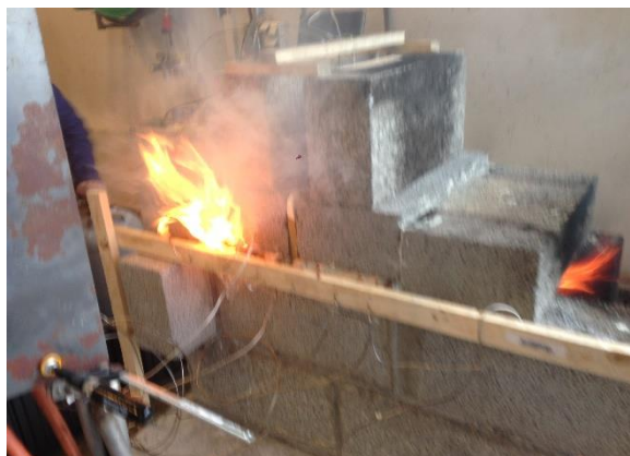
Bilde 6: Gjennombrenning og utstående flammning i fuge 1 forsøk 7
