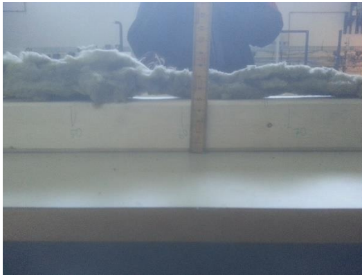
Figur 5 viser forskjellene i høyden, etter at riggen ble delt opp. Det er en differanse opptil 20 mm.
