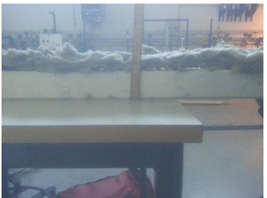
Figur 7, viser en mer jevn dyttings kvalitet enn på figur 5. Men ikke bedre enn figur 6.
