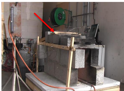
Bilde 8: Pilen viser stedet hvor det var svikt i fuge 5 i forsøk 10
