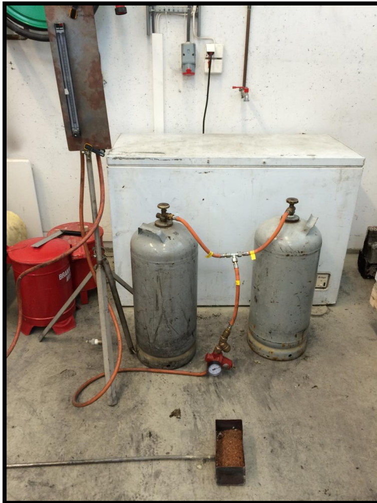
Figur 7 - Gassbrenner med tilhørende propantanker og måleinstrument
