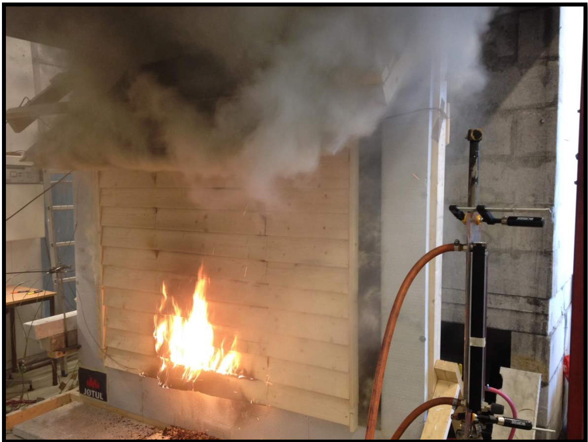
Figur 18 - Foto fra Forsøk 1, som viser brannspredning til fremside av kledning
