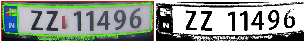
Figur 8.19 Behandling med terskelgrense 240 på bilde med god kvalitet
