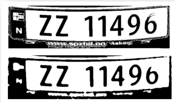
Figur 8.21 Registreringsnummer før og etter Median Filter - kompaktkamera
