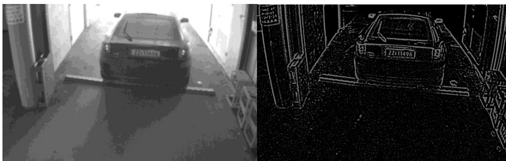
Figur 7.5 Bilde behandlet med Adaptive Threshold
