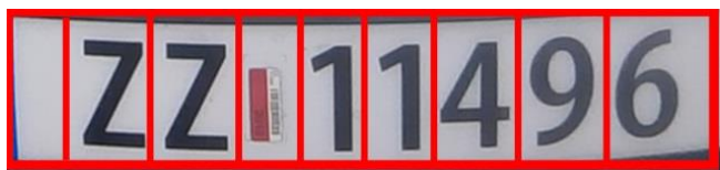
Figur 8.23 Hvert enkelt tegn detektert for seg
