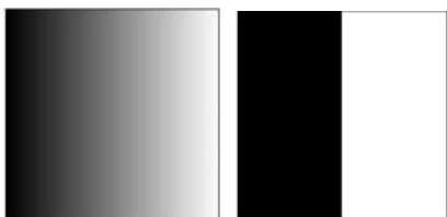
Figur 7.4 Eksempel omgjøring gråskalert til binært
