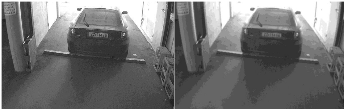
Figur 7.3 Bilde behandlet med Gaussian Blur
