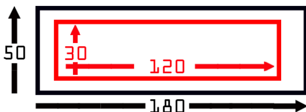
Figur 7.6 Nederste og øvre grense for størrelse registreringsskilt
