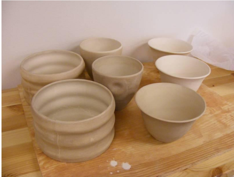
Figur 66. Ferdig støypte gjenstandar
