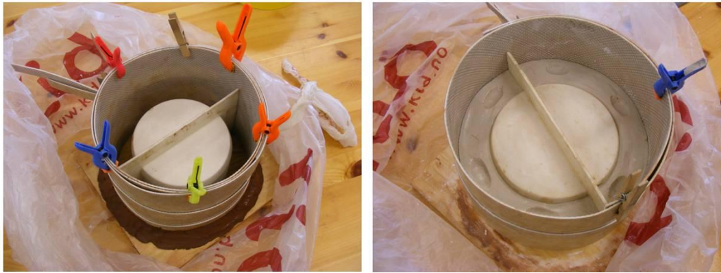
Figur 63. Støyping av gipsform
