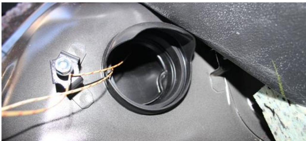
Figur 22 - Innføringspunkt for termoelementer til batteri
