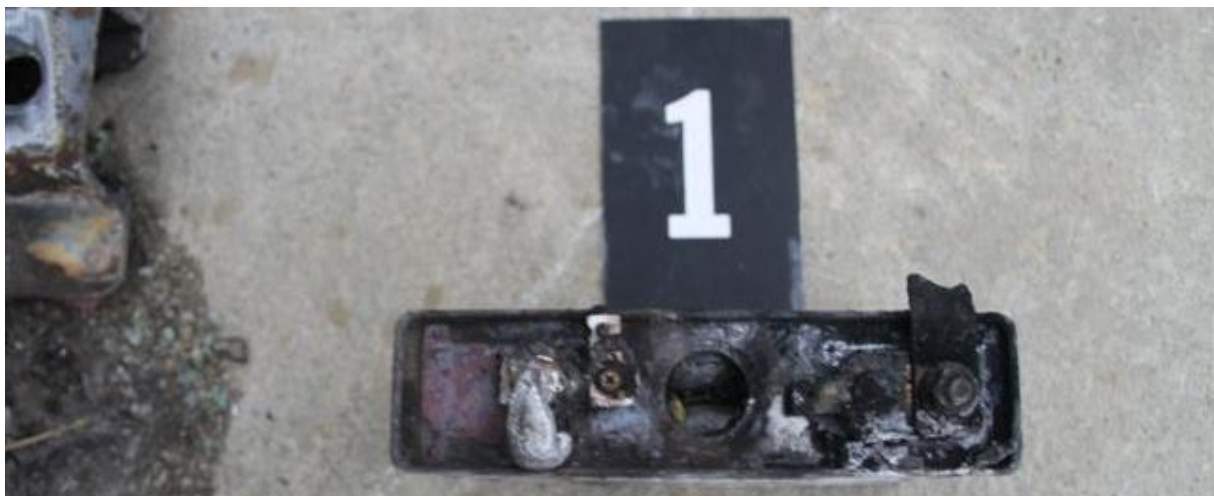
Figur 37 - Celle Cellenes ventiler pekete mot høyre side av bilen
