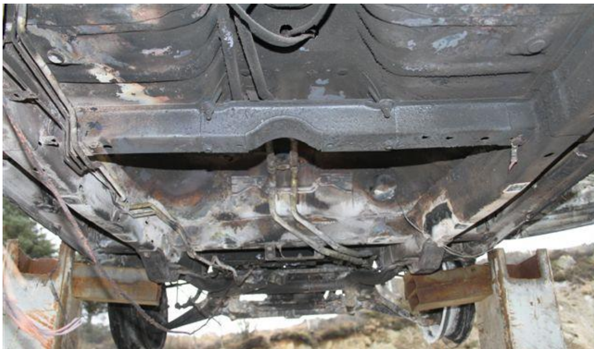
Figur 33 - Bilchassiset etter brannen
