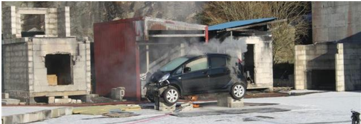
Figur 26 - Igangsetting av brannen med ekstern varmekilde
