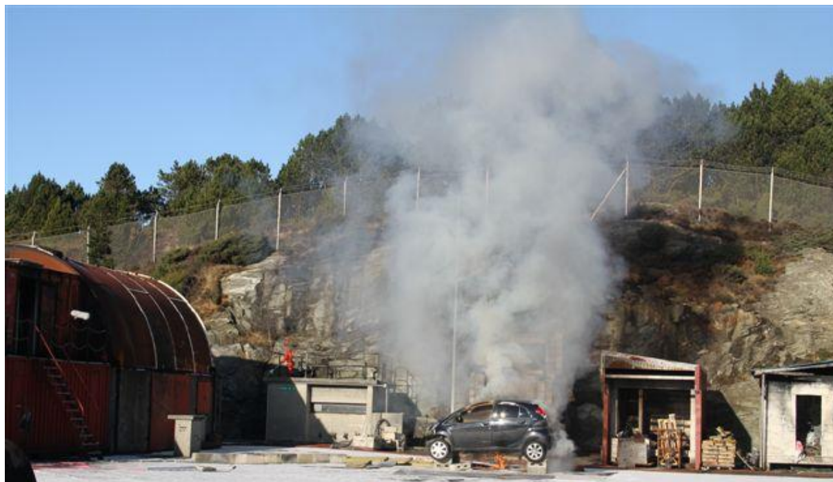
Figur 27 - Brannforløp uten ekstern varmekilde
