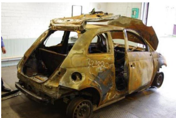
Figur 5 - EV-Adapt konvertert Fiat 500 etter brann
