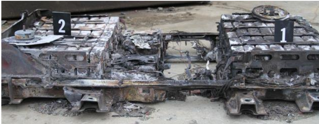
Figur 34 - Utbrent batteripakke 1. Foran i bilen, 2. Bak i bilen
