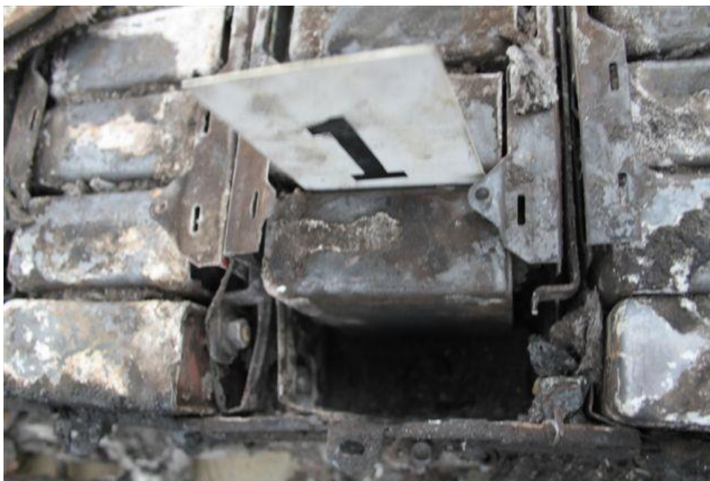
Figur 41 - Plassering av utplukket celle i bilbatteriet
