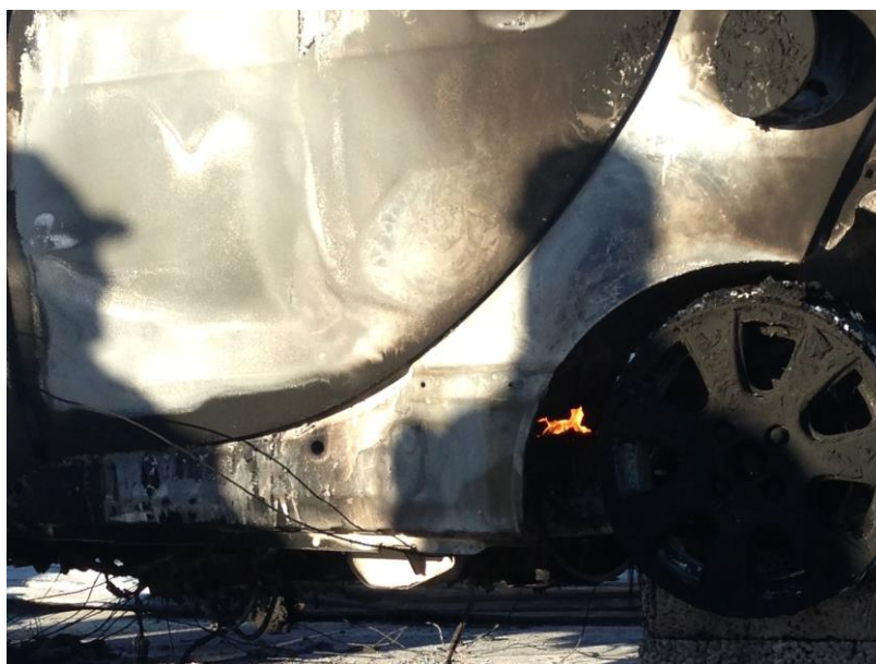
Figur 29 - Brann i bakre del av batteriet etter 90 minutter
