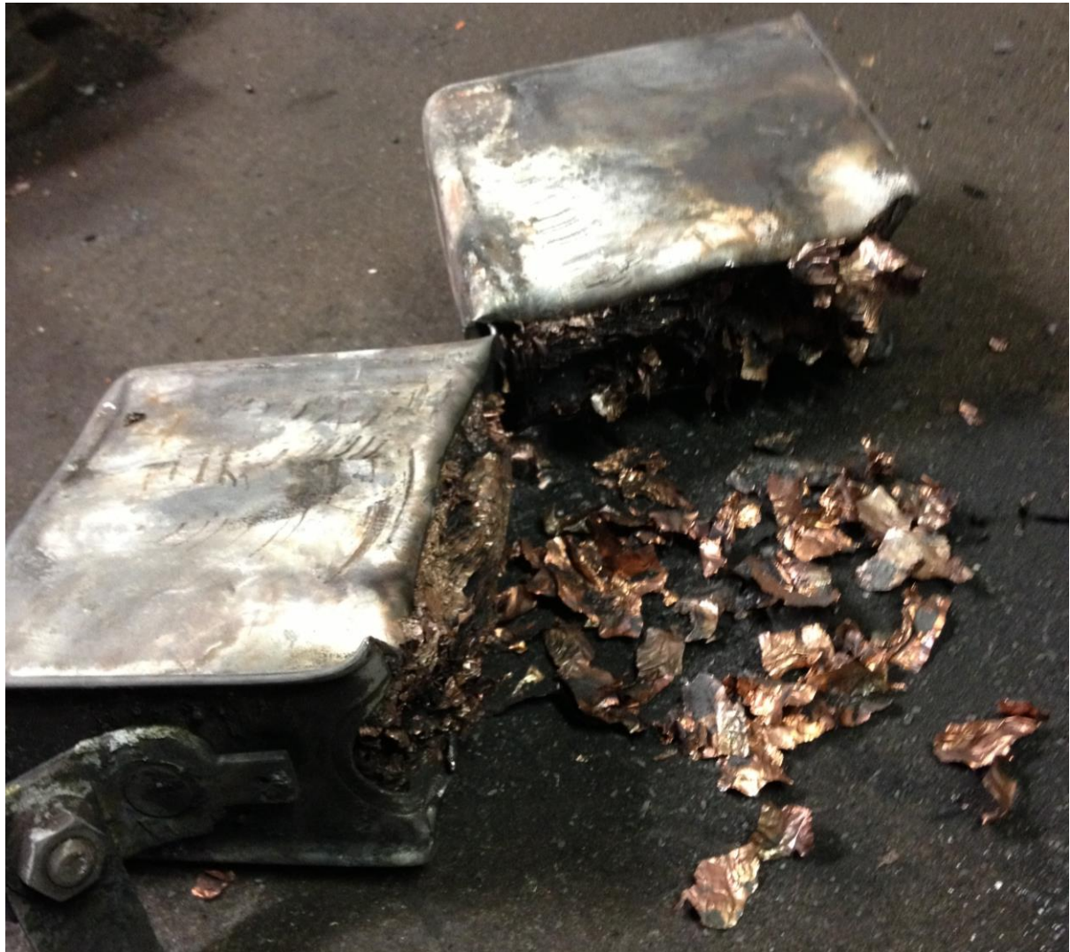
Figur 44 - Delt celle med utplukket innhold
