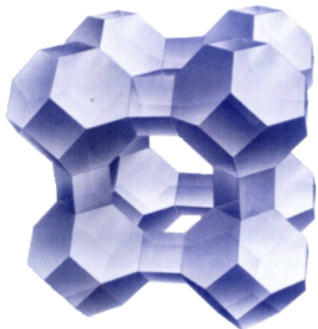
Figur 4-13 Utdrag av oppbygningen til en molekylsil. Hentet fra: http://www.molecularsieve.org/Zeolite_Molecular_Sieve.htm
